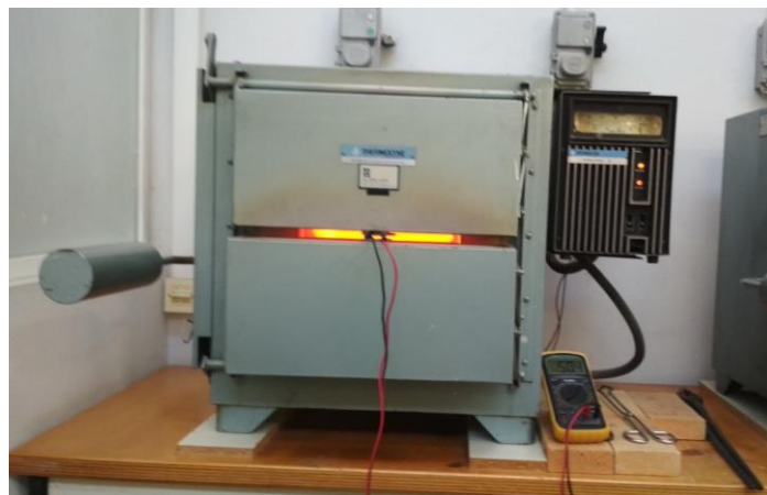
Εικόνα 17. Πειραματική διάταξη κατά την διάρκεια της θερμικής κατεργασίας
