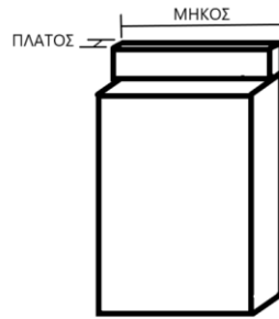
Εικόνα 27. Μετρήσεις επιφάνειας διατομής για υπολογισμό δυσθραυστότητας
