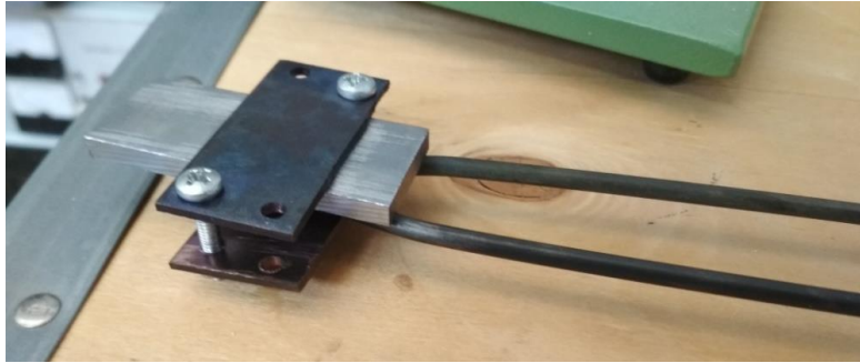
Εικόνα 16. Τρόπος σύνδεσης θερμοζεύγους και δοκιμίου.
