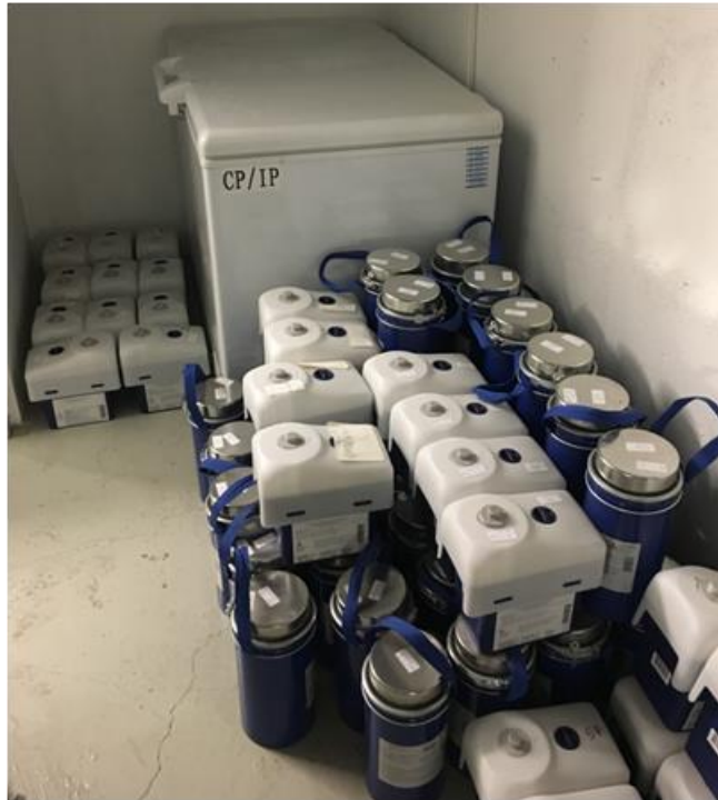
Εικ.92: Ψυγειοκαταψύκτης και γεννήτριες φύλαξης νοτισμένων αντικειμένων από θάλαμο θεραπείας I 131
