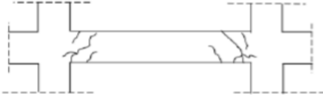
Εικόνα 3. 11: Διατμητική αστοχία δοκού (Δρίτσος, 2005)
