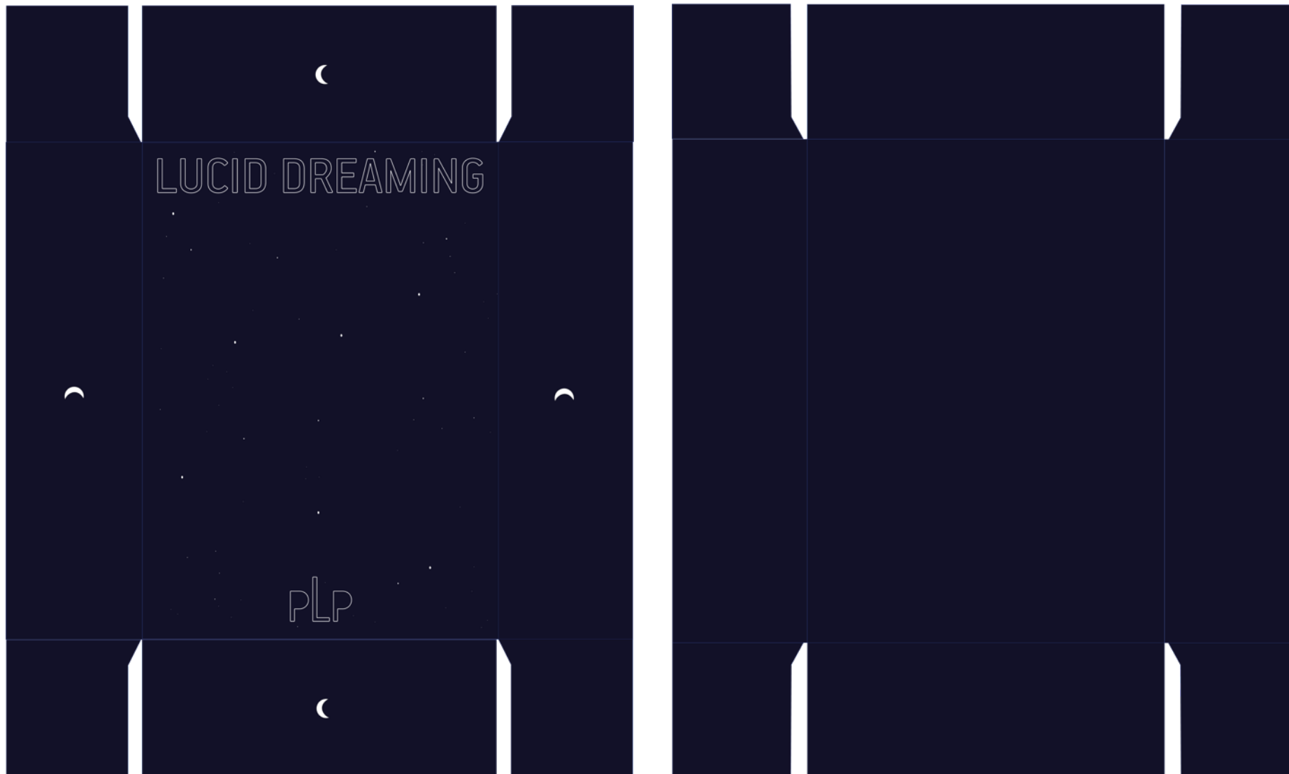
Ανάπτυγμα καπακιού και κάτω μέρους κουτιού
