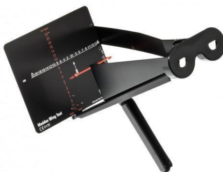
Εικόνα 2.12. Είναι μία από τις παραλλαγές της δοκιμασίας Maddox για την κοντινή μέτρηση. ( https://www.eyesfirst.eu/maddox-wing.html?store=en )
