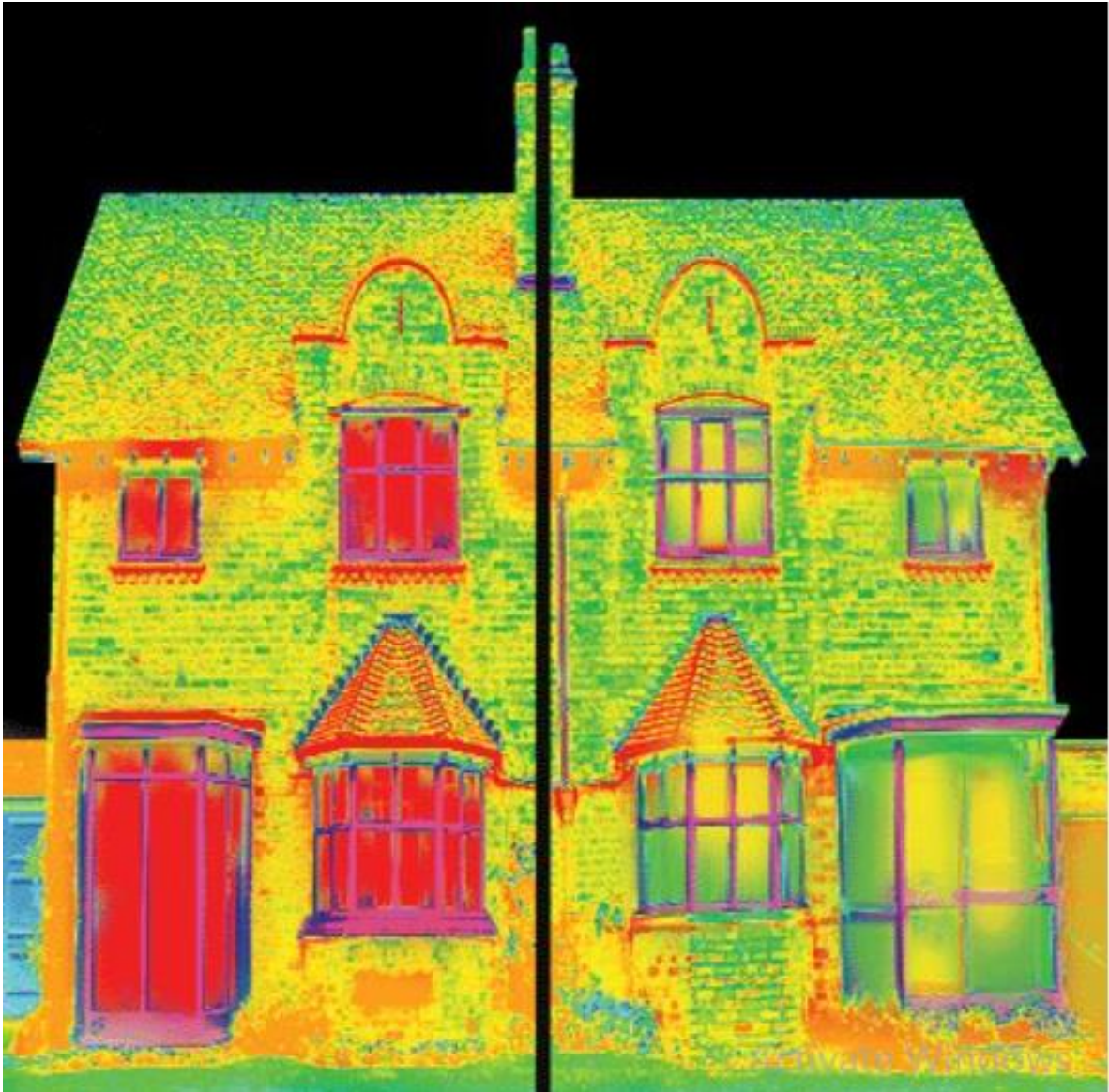
Εικόνα 2.15: Σύγκριση εισροής θερμότητας μεταξύ απλών και ενεργειακών κουφωμάτων αλουμινίου ( https://fenestral.gr/ )
