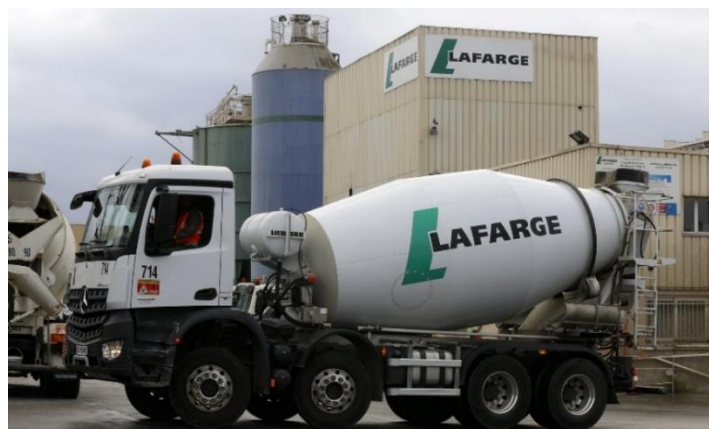
Εικόνα 72: Όχημα μεταφοράς σκυροδέματος – ‘Βαρέλα’
