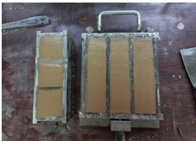
Εικ. 5.6: Εισαγωγή των συνθέσεων σε μεταλλικές μήτρες για πρισματικά και κυβικά δοκίμια
