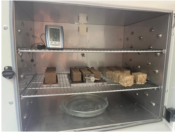
Εικ. 5.7: Τοποθέτηση των συνθέσεων σε θάλαμο ωρίμανσης
