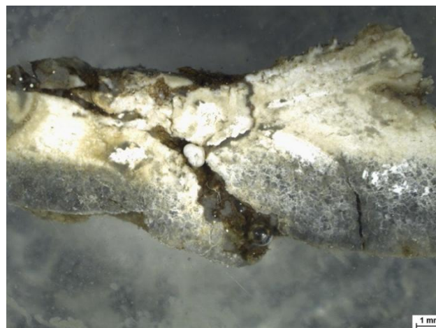
Εικ. 2.12: Φωτογραφία σε ΟΜ δείγματος από την περιοχή του ασβεστοκάμινου, παρατηρείται η διαφοροποίηση του ανώτερου στρώματος σε σχέση με το εσωτερικό του λίθου
