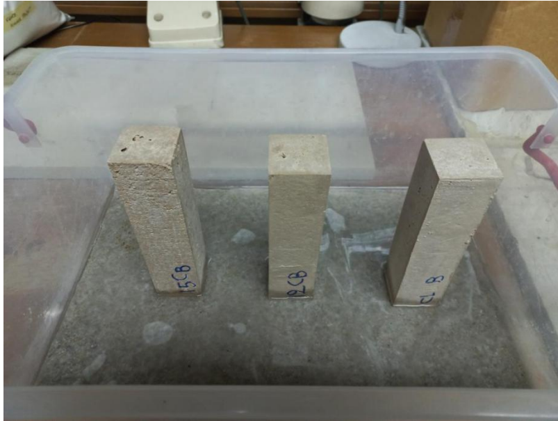
Εικ. 6.8: Δοκιμή τριχοειδούς αναρρίχησης.
