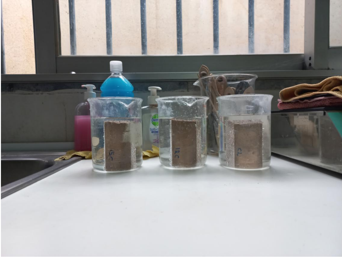
Εικ. 6.12: Δοκιμή ολικής εμβάπτισης.
