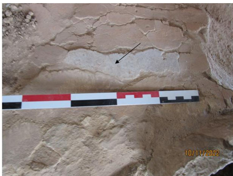
Εικ.86 Με μαύρο βέλος η περιοχή στο θρανίο του πίθου 3 στο Χώρο 23 όπου έγιναν οι μετρήσεις με pXRF και FTIR εξωτερικής ανάκλασης ώστε να διαφανεί αν υπάρχει χρώμα ή αποτύπωμα του.
