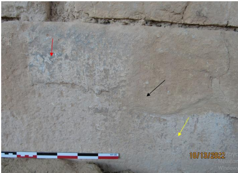
Εικ.92 Οι περιοχές όπου έγιναν οι μετρήσεις με pXRF και FTIR εξωτερικής ανάκλασης. Στο σημείο με το μαύρο βέλος δεν κατέστη δυνατή η μέτρηση με φασματοσκοπία υπερύθρου.
