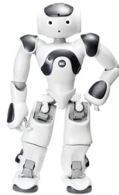
Εικόνα 19. Nao. Ο Nao είναι ένα μικρό ανθρωποειδές ρομπότ που έχει σχεδιαστεί για να αλληλεπιδρά με ανθρώπους. Πάνω του είναι τοποθετημένοι πολλοί αισθητήρες (και χαρακτήρας) και μπορεί να περπατήσει, να χορέψει, να μιλήσει και να αναγνωρίσει πρόσωπα και αντικείμενα. Βοηθά τα άτομα με αυτισμό να αλληλεπιδρούν καλύτερα με το περιβάλλον τους, να εκφράζουν τα συναισθήματά τους και να αναπτύξουν βασικές κοινωνικές και επικοινωνιακές δεξιότητες. Τώρα στην έκτη γενιά του, χρησιμοποιείται σε αρκετούς τομείς σε όλο τον κόσμο, όπως στην έρευνα, την εκπαίδευση, την υγειονομική περίθαλψη.
