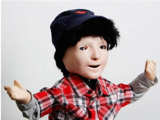
Εικόνα 18. Kaspar. Ο Kaspar έχει το μέγεθος ενός παιδιού και είναι ένα ανθρωποειδές ρομπότ, το πρόσωπο του οποίου έχει απλοποιημένα αλλά εκφραστικά χαρακτηριστικά. Έχει χρησιμοποιηθεί για θεραπεία με παιδιά με αυτισμό και ως ερευνητική πλατφόρμα για τη μελέτη της κοινωνικής ρομποτικής. Για την εξέλιξή του απαιτήθηκαν πάνω από δέκα χρόνια ερευνών από το Adaptive Systems Research Group του Πανεπιστημίου του Πανεπιστημίου του Hertfordshire.
