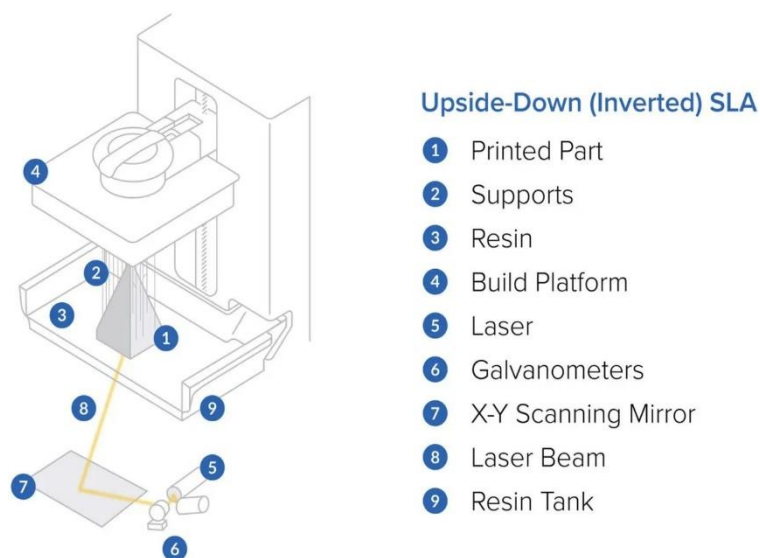
Εικόνα 7: Η μέθοδος της στερεολιθογραφίας (SLA) [13]
