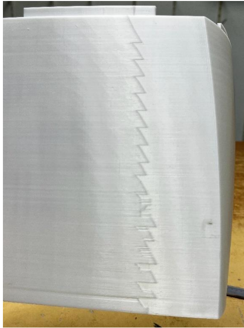
Εικόνα 59: Ελάττωμα εκτύπωσης στην επιφάνεια του Part2_Left
