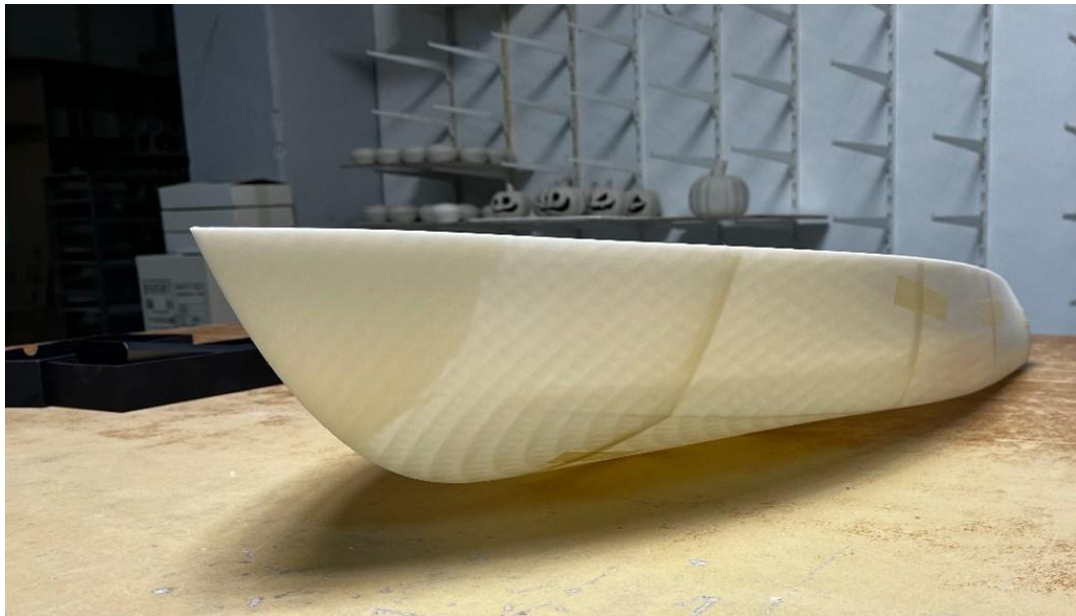
Εικόνα 63: Πλήρης συναρμολόγηση 3D printed μοντέλου ταχύπλου σκάφους
