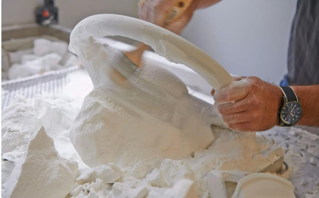
Εικόνα 9: Ανάκτηση του εκτυπωμένου αντικειμένου στη μέθοδο Selective Laser Sintering [13]
