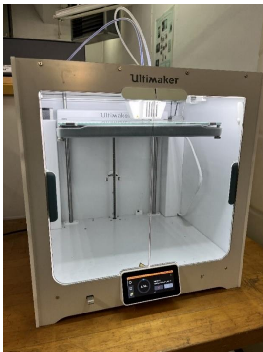
Εικόνα 42: Ο εκτυπωτής Ultimaker S5 τεχνολογίας FDM του Εργαστηρίου Μηχανουργικών Κατεργασιών
