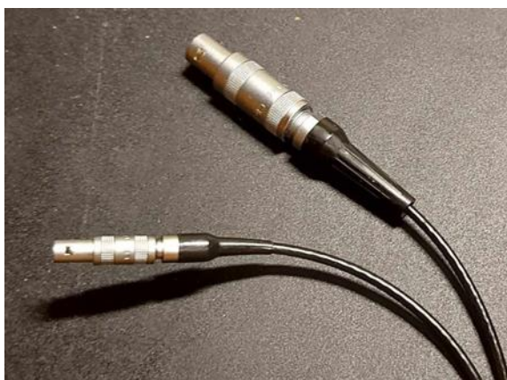
Εικόνα 3.31: Φαίνεται το καλώδιο που είναι μόνο πομπός [0].
