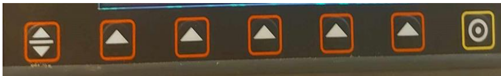
Εικόνα 3.42: Στην παραπάνω εικόνα βλέπουμε από τα αριστερά προς τα δεξιά το κουμπί της αλλαγής μεταξύ των επιπέδων λειτουργίας, μετά την επιλογή των ομάδων λειτουργίας και τέρμα αριστερά βλέπουμε το πλήκτρο ενεργοποίησης και απενεργοποίησης [0].
