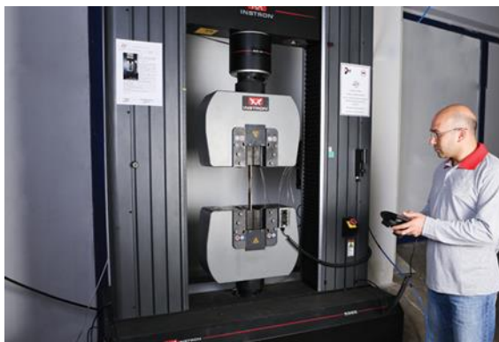
Εικόνα 1.8: Δοκιμή τάσης/ εφελκυσμού [0].
