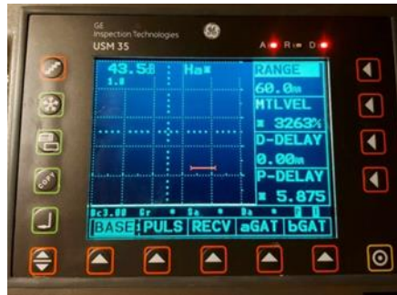
Εικόνα 4.5: Στην παραπάνω εικόνα βλέπουμε κάτω από την γραμμή ρυθμίσεων την εντολή BASE και στα δεξιά το MTLVEL που είναι η ταχύτητα διάδοσης του σήματος [0].
