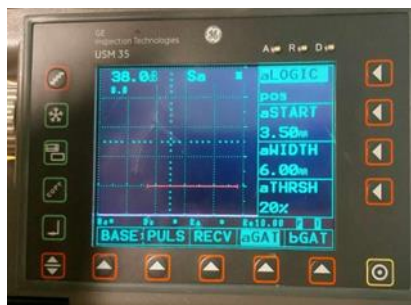
Εικόνα 4.2: Στην παραπάνω εικόνα το κίτρινο τετράγωνο κουμπί που βρίσκεται κάτω δεξιά είναι το κουμπί του on/off [0].
