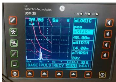
Εικόνα 4.25: Στην παραπάνω εικόνα βλέπουμε στο σημείο που έχει το σφάλμα γιατί παρουσιάζονται δύο καμπύλες [0].
