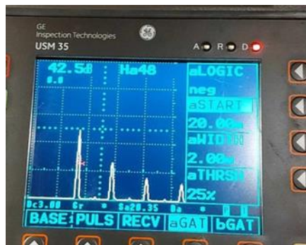
Εικόνα 4.14: Στην παραπάνω εικόνα βλέπουμε το πάχος του δοκίμιου που είναι 20.35mm. [0].
