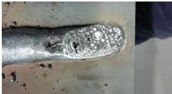
Εικόνα 1.22: Περίπτωση της ατέλεια όταν η συγκόλληση μας έχει περίσσεια αέρα [0].
