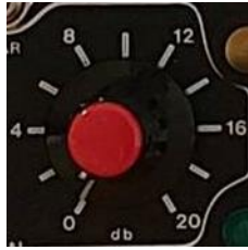
Εικόνα 3.12: Στην παραπάνω εικόνα βλέπουμε τον ρυθμιστή ευαισθησίας [0].
