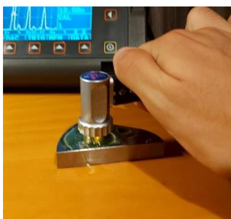
Εικόνα 4.10: Στην παραπάνω εικόνα βλέπουμε την τοποθέτηση της κεφαλής πάνω στο πρότυπο υλικό [0].
