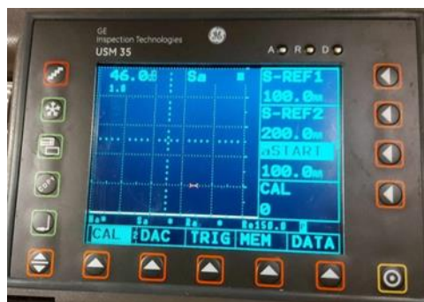
Εικόνα 4.20: Στην παραπάνω εικόνα βλέπουμε κάτω από την γραμμή ρυθμίσεων την εντολή CAL και στα δεξιά το S-REF1 που είναι η απόσταση που διανύει το σήμα μέχρι να φτάσει στην άλλη άκρη και το S-REF2 που είναι η απόσταση που διανύει το σήμα από την κεφαλή μέχρι την μία άκρη και ξανά να φτάσει στην κεφαλή [0].
