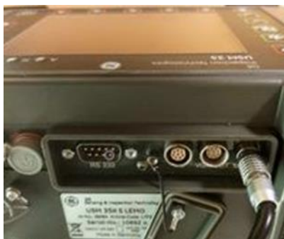
Εικόνα 4.1: Στην παραπάνω εικόνα στα δεξιά βλέπουμε το καλώδιο ρεύματος του μηχανήματος [0].
