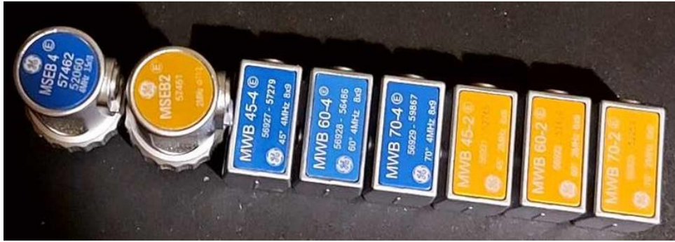
Εικόνα 3.29: Στην παραπάνω εικόνα φαίνονται όλες οι κεφαλές που έχει το μηχάνημα και οι κεφαλές με το μπλε χρώμα είναι αυτές που έχουν συχνότητα 4Hz ενώ αυτές που είναι με κίτρινο χρώμα έχουν 2 Hz. Επίσης, οι δύο πρώτες κεφαλές είναι οι κάθετες ενώ οι άλλες 4 είναι αυτές με την γωνία [0].
