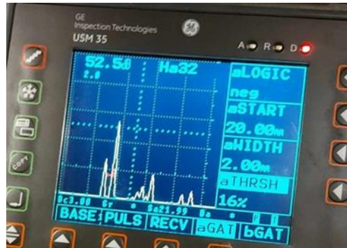
Εικόνα 4.15: Στην παραπάνω εικόνα βλέπουμε στα αριστερά που έχουν δημιουργηθεί δύο καμπύλες αυτό δηλώνει πως υπάρχει σε αυτό το σημείο κάποια αστοχία στο υλικό [0].
