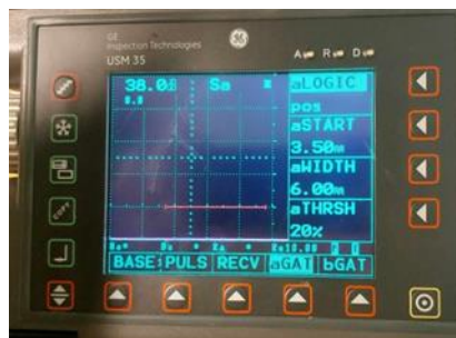
Εικόνα 3.55: Στην παραπάνω εικόνα η κόκκινη γραμμή μας δείχνει το μήκος της και το ύψος της πύλης το τροποποιούμε με τις εντολές STAR, WIDTH, THRSH[0].
