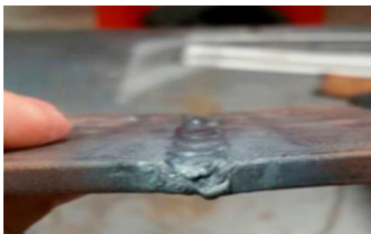
Εικόνα 1.18: Περίπτωση κακής γωνιακής ευθυγράμμισης [0].
