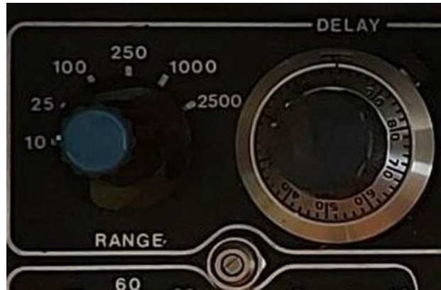
Εικόνα 3.13: Από τα αριστερά προς τα δεξιά βλέπουμε τον επιλογέα περιοχής ή βάθους. Επίσης, στην μέση κάτω το μεταλλικό στοιχείο είναι για την ρύθμιση ευαισθησίας της συνεχούς μεταβολής. Τέλος στα δεξιά μπορούμε να αντικρίσουμε τον ρυθμιστή μετατόπισης [0].
