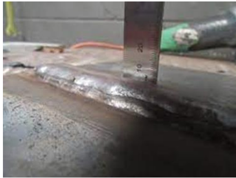
Εικόνα 1.19: Μία περίπτωση κακής γωνιακής ευθυγράμμισης [0].
