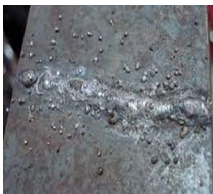
Εικόνα 1.16: Αστοχία της περίπτωση του πιτσιλίσματος [0].
