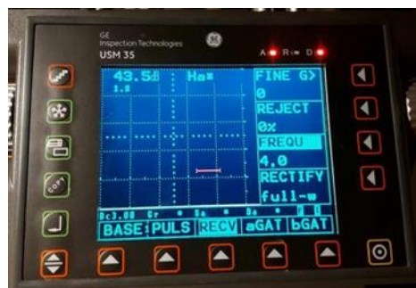
Εικόνα 4.18: Στην παραπάνω εικόνα βλέπουμε κάτω από την γραμμή ρυθμίσεων την εντολή RECV και στα δεξιά το FREQU που είναι η συχνότητα και θα επιλέξουμε την συχνότητα που έχει η κεφαλή [0].
