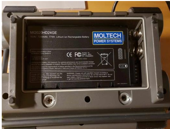
Εικόνα 3.33: Στην πίσω πλευρά φαίνεται αν βγει το καπάκι ασφάλεια την μπαταρία του μηχανήματος [0].
