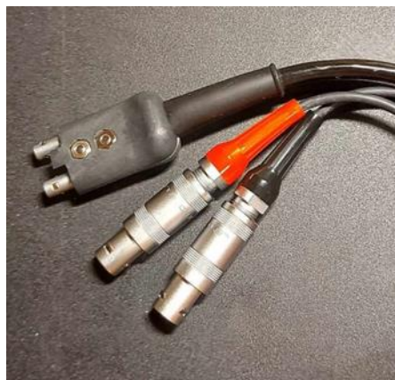
Εικόνα 3.30: Στην παραπάνω εικόνα φαίνεται το καλώδιο που είναι και πομπός και δέκτης [0].
