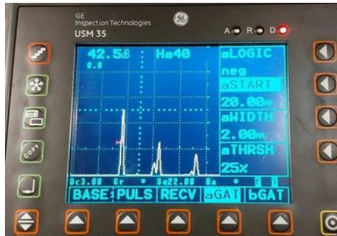
Εικόνα 4.13: Στην παραπάνω εικόνα βλέπουμε το πάχος του δοκίμιου που είναι 22mm [0].
