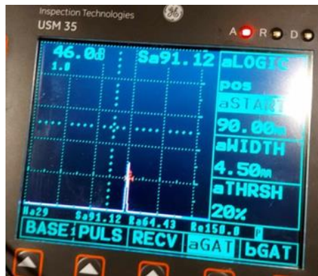
Εικόνα 4.23: Στην παραπάνω φωτογραφία βλέπουμε το μέγιστο σημείο για την εύρεση του X-VALU [0].
