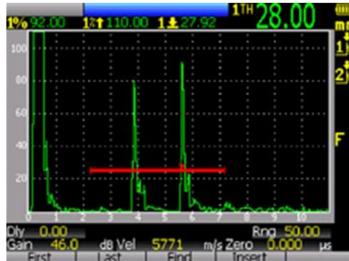
Εικόνα 2.8: Οθόνη σάρωσης στην ανιχνευτή ελαττωμάτων υπερήχων [0].
