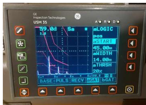
Εικόνα 4.26: Στην παραπάνω εικόνα βλέπουμε ένα άλλο σφάλμα αλλά υπάρχει και μία δευτέρα καμπύλη επειδή έχω γωνιακή κεφαλή πιάνει και δευτερο σημείο με σφάλμα [0].
