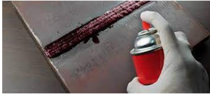
Εικόνα 1.4: Δοκιμή με διεισδυτικό υγρό [0].
