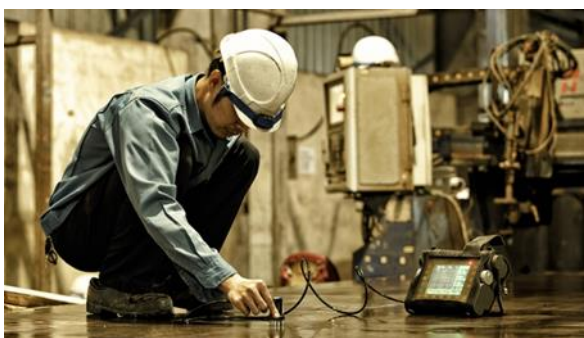
Εικόνα 1.6: Έλεγχος με την χρήση συσκευής υπέρηχων [0].
