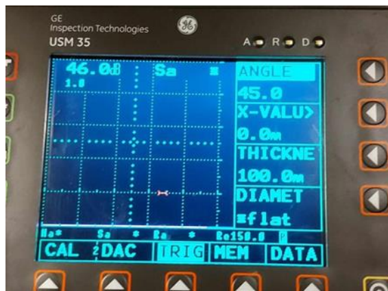
Εικόνα 4.21: Στην παραπάνω εικόνα βλέπουμε κάτω από την γραμμή ρυθμίσεων την εντολή TRIG και στα δεξιά το ANGLE που είναι η γωνία της κεφαλής το X-VALU που είναι από ποιο σημείο εκπέμπει η κεφαλή το σήμα και το THICKNE που είναι το πάχος του υλικού [0].
