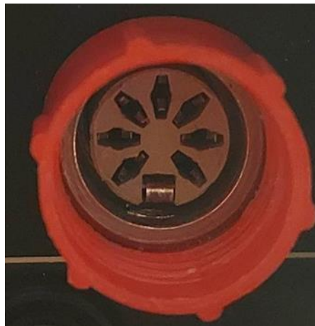
Εικόνα 3.5: Το εσωτερικό του βύσματος φόρτισης και των ακουστικών [0].
