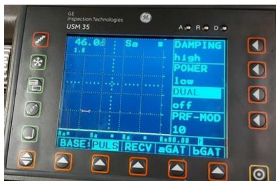
Εικόνα 4.17: Στην παραπάνω εικόνα βλέπουμε κάτω από την γραμμή ρυθμίσεων την εντολή PULS και στα δεξιά το DUAL που είναι για την κεφαλή αν είναι μόνο πομπός ή πομπός και δέκτης [0].
