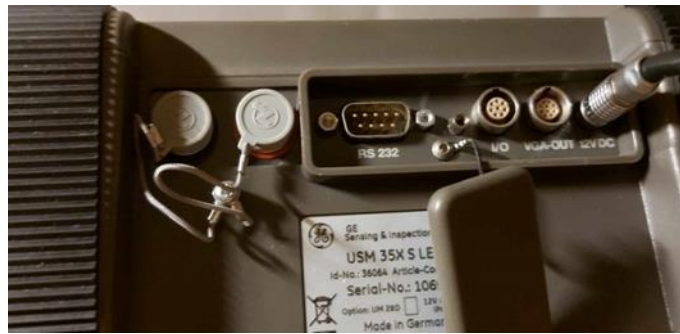
Εικόνα 3.32: Στην παραπάνω εικόνα φαίνεται το καλώδιο του τροφοδοτικού που έχει τοποθετηθεί στο βύσμα του [0].
