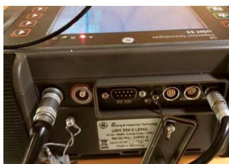
Εικόνα 4.4: Στην παραπάνω εικόνα βλέπουμε το καλώδιο με την μονή υποδοχή που είναι μόνο πομπός και όχι δέκτης [0].
