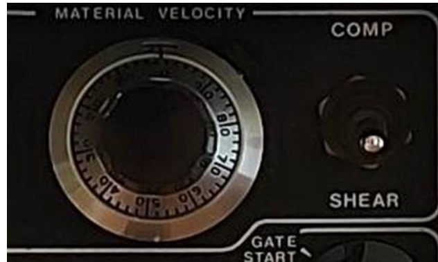
Εικόνα 3.14: Αριστερά μπορούμε να δούμε τον ρυθμιστή περιοχής βάθους και δεξιά τον επιλογή κάθετου γωνιακής κεφαλής [0].
