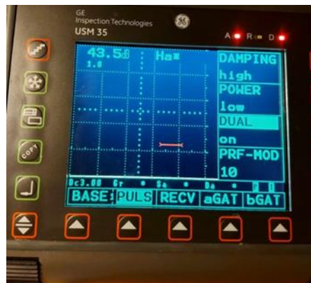
Εικόνα 4.6: Στην παραπάνω εικόνα βλέπουμε κάτω από την γραμμή ρυθμίσεων την εντολή PULS και στα δεξιά το DUAL που είναι για την κεφαλή μας αν είναι μόνο πομπός ή πομπός και δέκτης [0].
