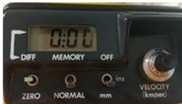
Εικόνα 3.21: Σε αυτήν την εικόνα φαίνεται σε λειτουργία το μηχανήμα. Ο διακόπτης OFF/ON είναι ο τρίτος από τα αριστερά προς τα δεξιά. Προσοχή να επιλέξω σωστές μονάδες [58].
