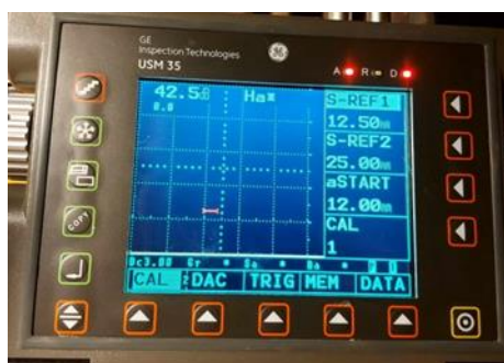
Εικόνα 4.9: Στην παραπάνω εικόνα βλέπουμε κάτω από την γραμμή ρυθμίσεων την εντολή CAL και στα δεξιά το S-REF1 που είναι η απόσταση που διανύει το σήμα μας μέχρι να φτάσει στην άλλη άκρη και το S-REF2 που είναι η απόσταση που διανύει το σήμα μας από την κεφαλή μέχρι την μία άκρη και ξανά να φτάσει στην κεφαλή [0].
