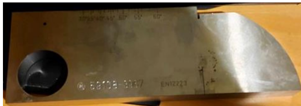
Εικόνα 4.19: Στην παραπάνω εικόνα βλέπουμε το πρότυπο δοκίμιο K1. [0].
