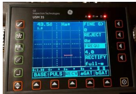
Εικόνα 4.7: Στην παραπάνω εικόνα βλέπουμε κάτω από την γραμμή ρυθμίσεων την εντολή RECV και στα δεξιά το FREQU που είναι η συχνότητα και θα επιλέξουμε την συχνότητα που έχει η κεφαλή [0].
