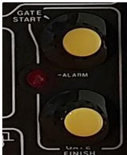
Εικόνα 3.15: Πάνω είναι ο ρυθμιστής αρχικής πύλης μετά βρίσκεται η ένδειξη προειδοποίησης αλαρμ και τέλος κάτω βρίσκεται ο ρυθμιστής τέλος πύλης [0].
