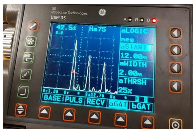
Εικόνα 4.11: Στην παραπάνω εικόνα βλέπουμε κάτω από την γραμμή ρυθμίσεων την εντολή aGAT και στα δεξιά το aSTART, το aWIDTH και το aTHRSH με αυτά θα τα τροποποιήσω για να δω το σήμα [0].
