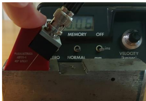
Εικόνα 3.23: Τοποθέτηση του δοκιμίου μας με την τοποθέτηση της κεφαλής και πίσω στην οθόνη μας έχει βγάλει τα αποτελέσματα μας [0].
