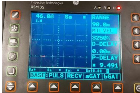
Εικόνα 4.16: Στην παραπάνω εικόνα βλέπουμε κάτω από την γραμμή ρυθμίσεων την εντολή BASE και στα δεξιά το MTLVEL που είναι η ταχύτητα διάδοσης του σήματος [0].
