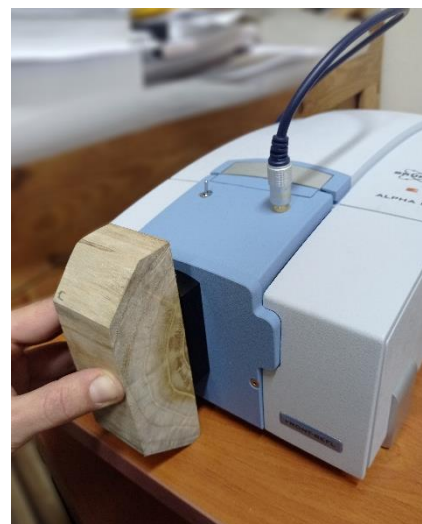
Εικόνα 2.24 Λήψη εγκάρδιου φάσματος στο εγκάρδιο τμήμα της εφαπτομενικής διεύθυνσης δοκιμίου με φασματόμετρο Bruker Alpha II FTIR.
