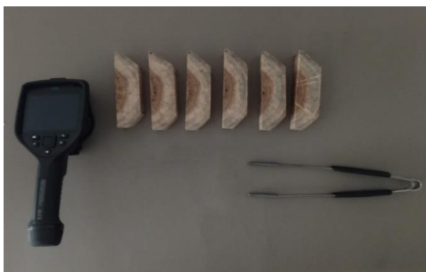
Εικόνα 2.23 Θερμική κάμερα υπερύθρου με δοκίμια Δ1-Δ6 και πλαστική λαβίδα σε γκρι πλαστικό υπόστρωμα.
