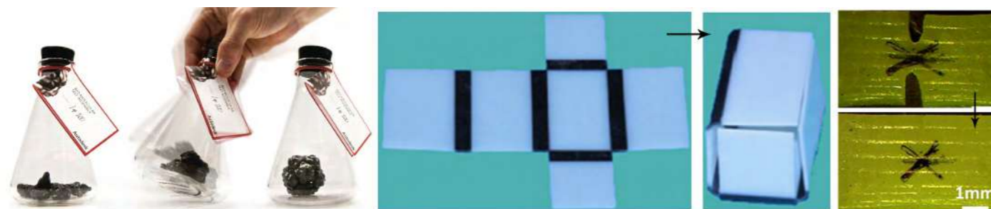
Αυτοσυναρμολόγηση κατά την ανακίνηση της φιάλης. Το ενεργό origami ενεργοποιείται με τη θερμοκρασία και αποκτά 3D δομή από "Digital SMP". Αυτοθεραπεία που πραγματοποιείται με θέρμανση στους 80° για 20 λεπτά, και ψύξη στον αέρα. Πηγές: https://metropolismag.com/viewpoints/skylar-tibbits-materials-science/ https://metropolismag.com/viewpoints/skylar-tibbits-materials-science/ https://www.frontiersin.org/files/Articles/873453/fbioe-10-873453-HTML/image_m/fbioe-10-873453-g003.jpg
