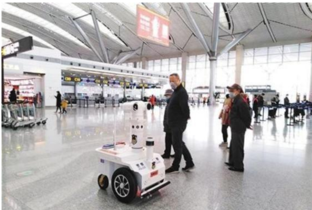
Σχήμα 16 Ρομπότ περιπολίας για τήρηση μέτρων κοροναϊού στο αεροδρόμιο Guiyang της Κίνας
