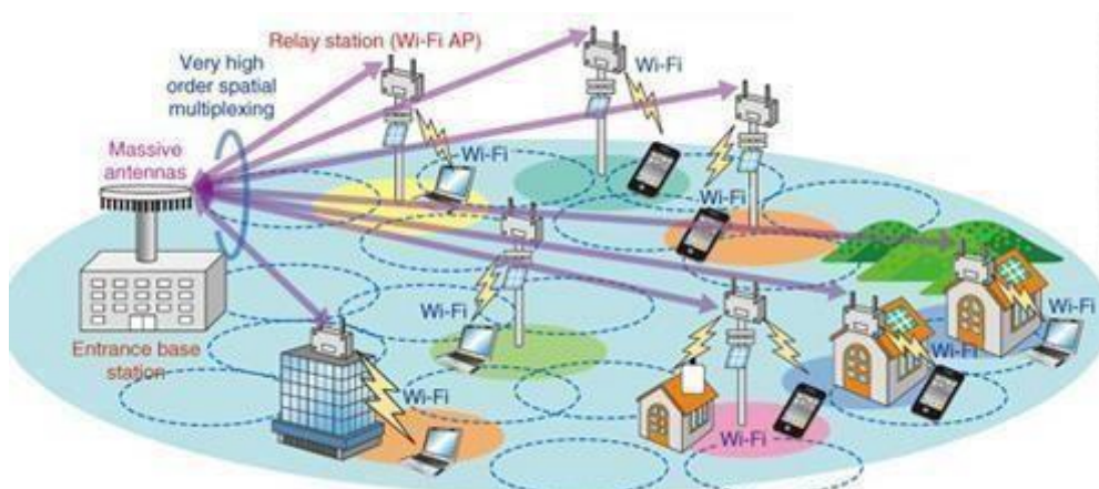
Εικόνα 9. Παράδειγμα χρήσης κεραίας διαμόρφωσης δέσμης για τη σύνδεση σημείων πρόσβασης Wi-Fi [15]
