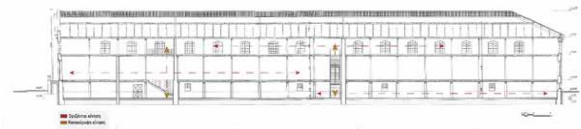
Εικόνα 56: << Διάγραμμα κατακόρυφης και οριζόντιας κίνησης εργατών Καπναποθήκης Π>>.
