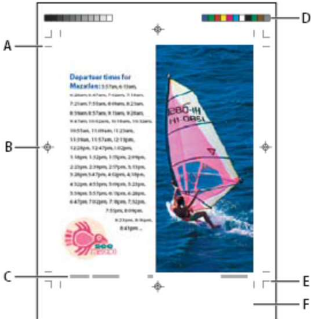
Εικόνα 7 : A. Crop marks B. Registration mark C. Page information D. Color bars E. Bleed marks F. Slug area
