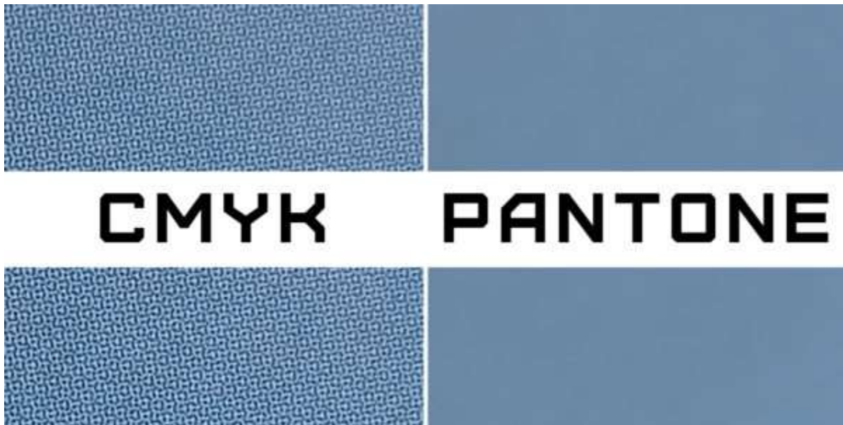
Εικόνα 31 : Ημιτονική πλοκή των τεσσάρων μελανιών στα αριστερά της εικόνας για παραγωγή γαλάζιου χρώματος με CMYK, στην δεξιά εικόνα πλακάτο μελάνι της Pantone για αντίστοιχη απόχρωση
