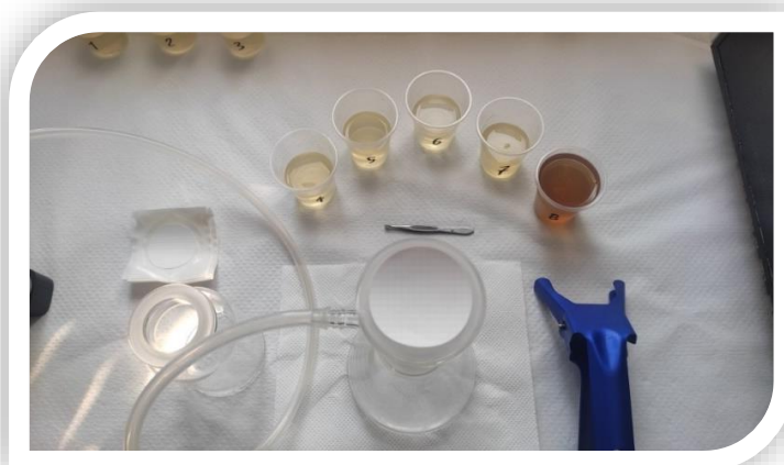
Εικόνα 3.0.2 Σύστημα Αντλίας Κενού
