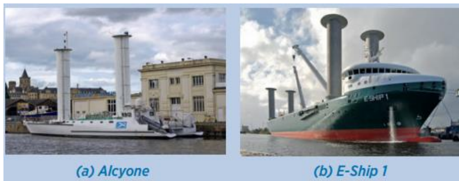
Εικόνα 10: Πλοία με τεχνολογία ρότορα (φαινόμενο Magnus) [22]
