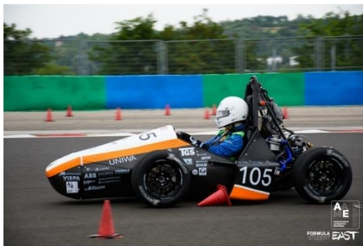
Εικόνες 10 & 11: Οχήματα Formula Student με ζάντες διαμέτρου 13 ιντσών και 10 ιντσών αντίστοιχα
