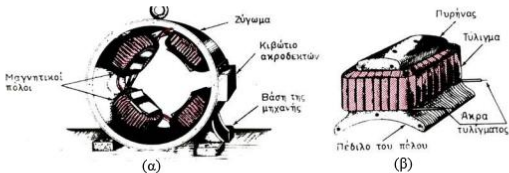
Εικόνα 2.3: (α) Στάτης κινητήρα, (β) μαγνητικός πόλος.
