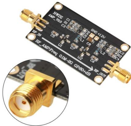
Σχήμα 32. Η πρώτη πλακέτα κέρδους 60dB με τους δύο INA 2186
