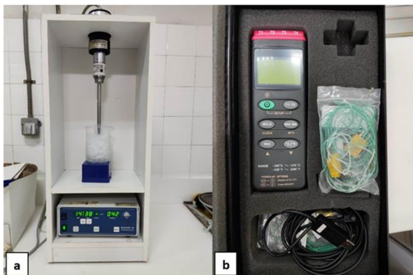
Εικόνα 3.2: (a) Η οργανολογία για την εκχύλιση με υπερήχους (UAE) και (b) το θερμοστοιχείο για την καταγραφή της θερμοκρασίας εκχύλισης.
