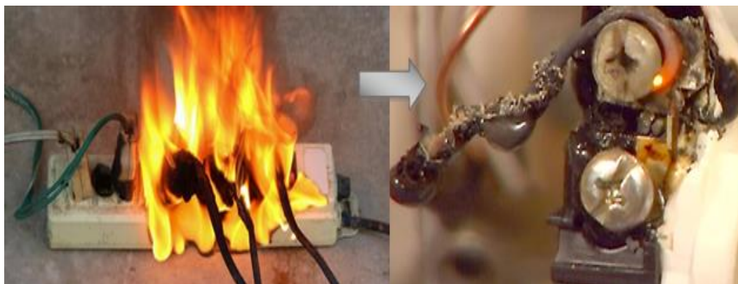
Εικόνα 2.11: Αναπαράσταση ηλεκτρικής πυρκαγιάς εξαιτίας υπερθέρμανσης. [45]
