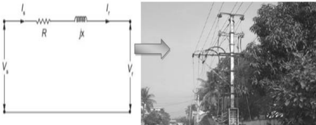
Εικόνα 1.10: Σχηματική απεικόνιση μιας γραμμής μεταφοράς μικρού μήκους. [28]
