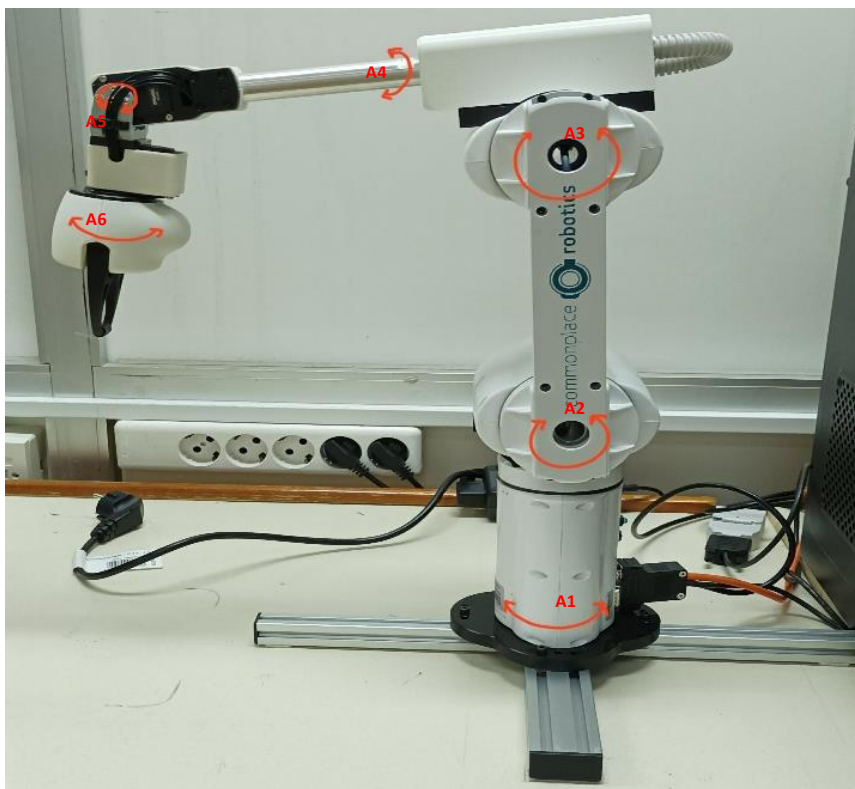
Εικόνα 8 : Ρομποτικός βραχίονας Mover 6 της εταιρίας Commonplace Robotics ( Με κόκκινο χρώμα επισημαίνονται οι αρθρώσεις του βραχίονα)
