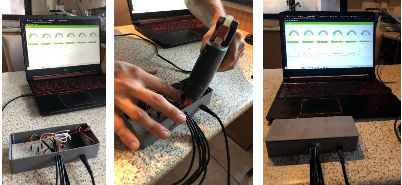
Εικόνα 22 Διαδικασία Θερμοκόλλησης με Σιλικόνη
