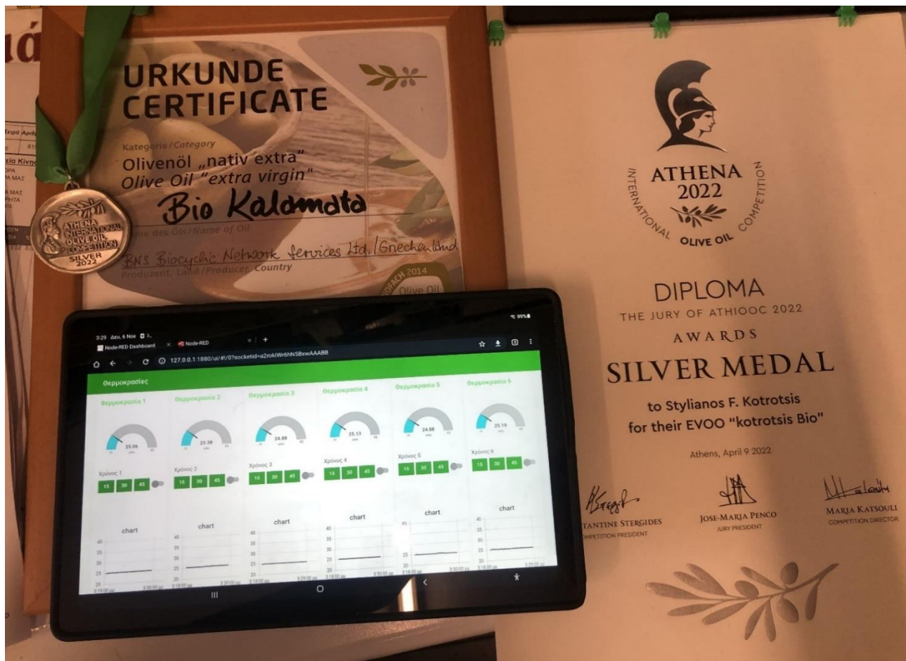
Εικόνα 25 Το Σύστημα συλλογής μετρήσεων αναπαριστά τις θερμοκρασίες στη Διεπαφή χρήστη μέσω τάμπλετ που εγκαταστήθηκε στο χώρο των μηχανημάτων.
