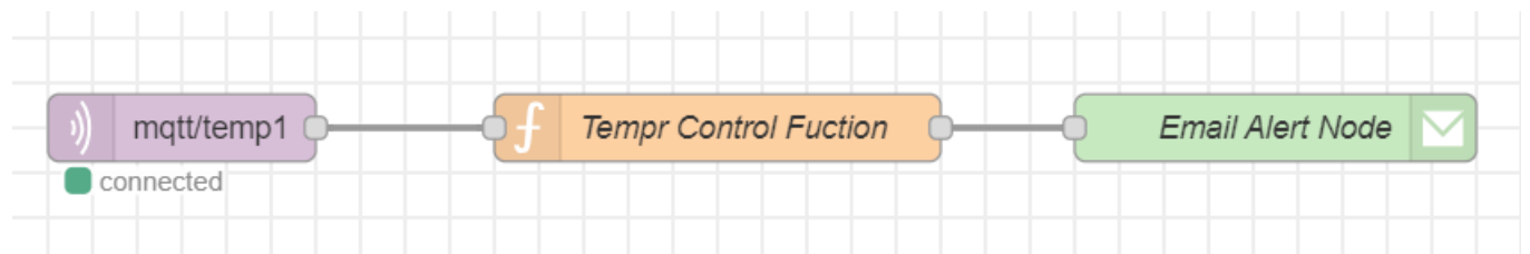
Εικόνα 13 Απεικόνιση σύνδεσης κόμβων για την εποπτεία θερμοκρασιών
