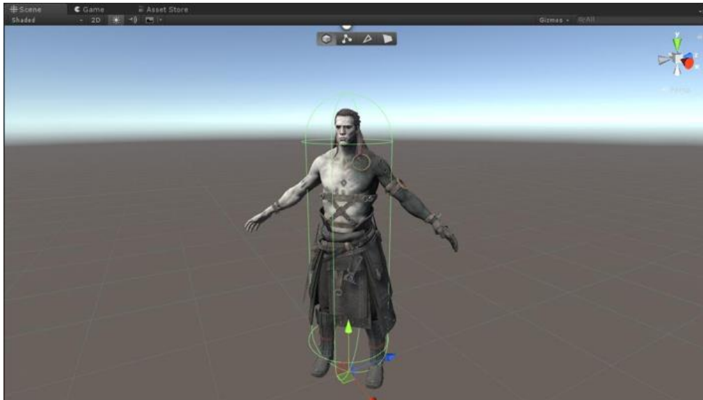
Εικόνα 2.2 Παράδειγμα κυλινδρικού Collider σε μοντέλο παίκτη
