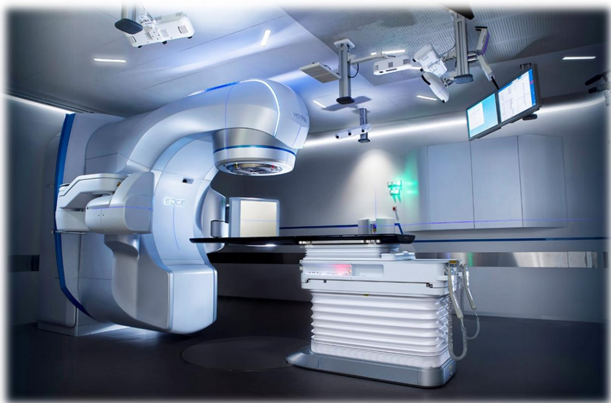
Εικόνα 22. Γραμμικός επιταχυντής EDGE της εταιρείας VARIAN .
