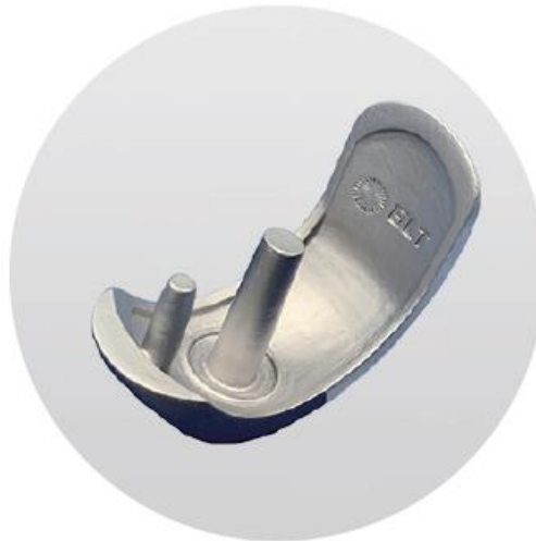
Εικόνα 13 Εκτυπωμένος μηριαίος κόνδυλος (xa-blт.com.2023).
