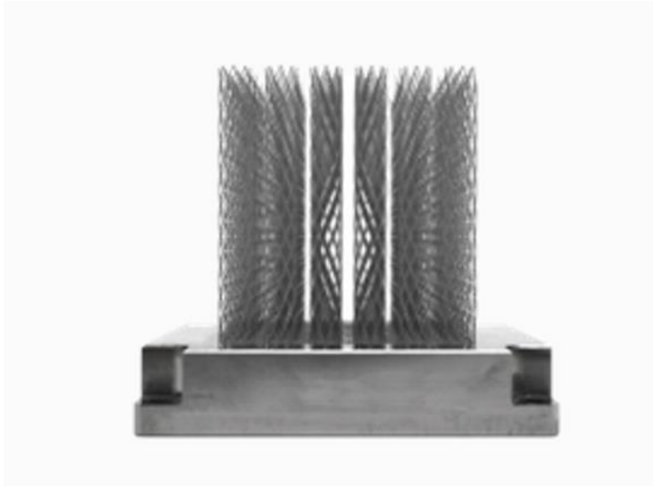
Εικόνα 12 Εκτυπωμένο στεντ (xa-blt.com.2023).
