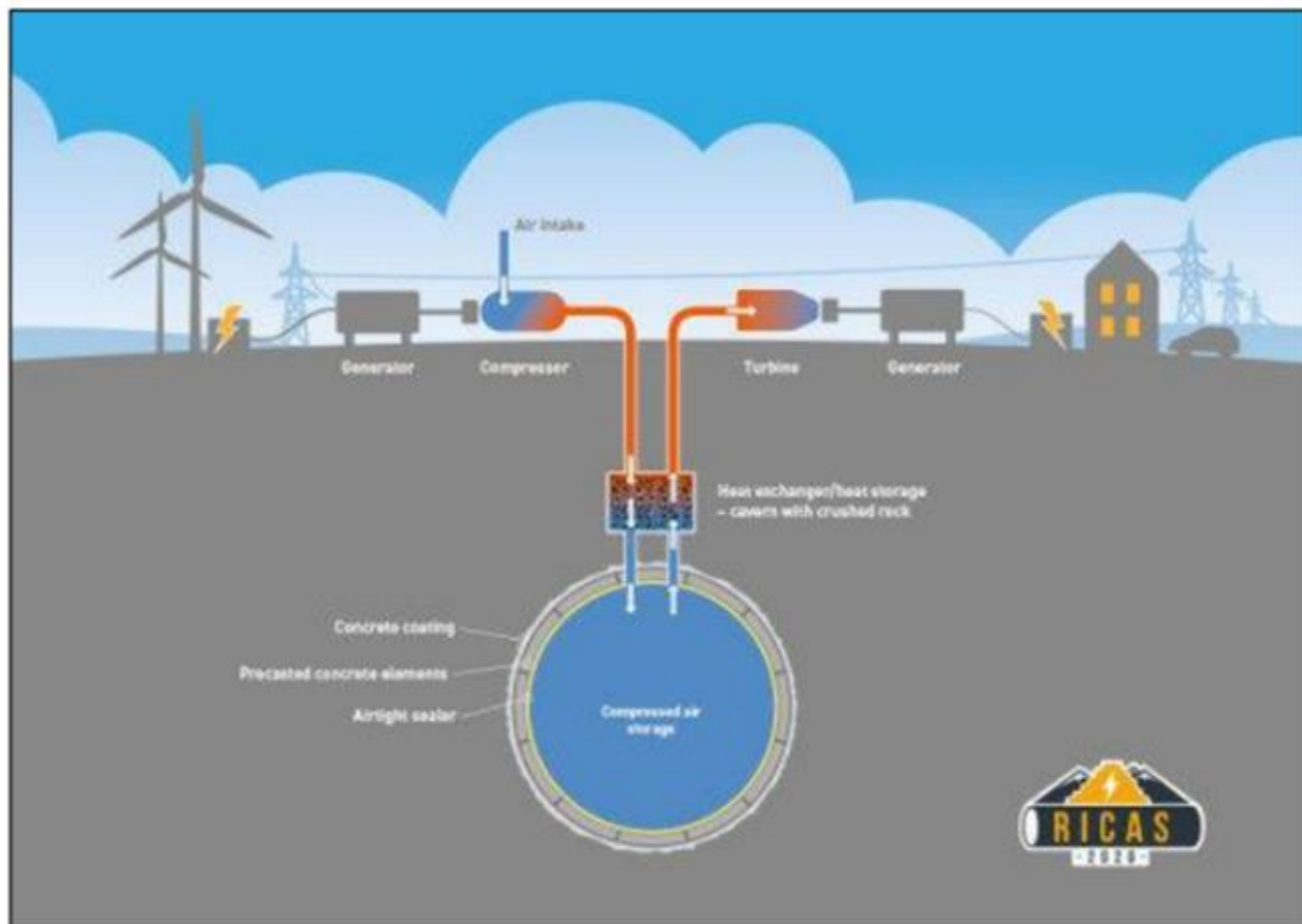
Εικόνα 3.3: Αποθήκευση ηλεκτρικής ενέργειας με χρήση πεπιεσμένου αέρα (Πηγή: Διπλωματική Εργασία: Αποθήκευση Ηλεκτρικής Ενέργειας: Τεχνολογίες και ρυθμιστικό πλαίσιο, Οδυσσέας Χαλατσάκος)
