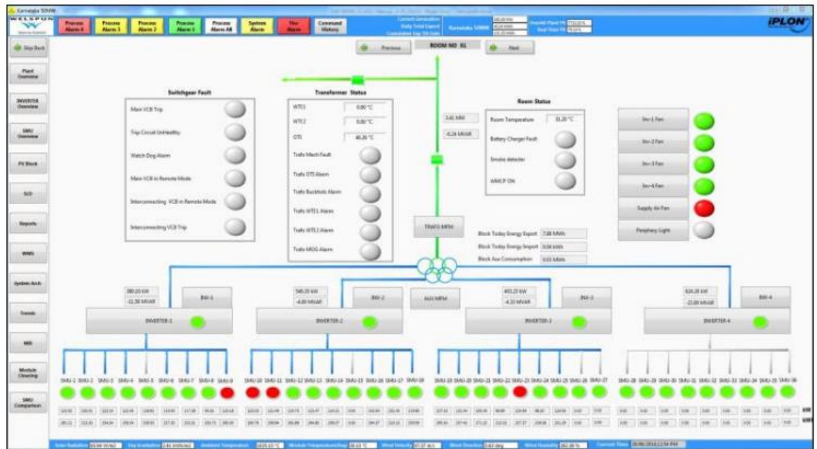
Εικόνα 5.13:Οθόνη SCADA: Γραφική επισκόπηση του συστήματος αποθήκευσης, συνήθως είναι η πρώτη εικόνα που βλέπει ο χειριστής, όπου γρήγορα φαίνεται η κατάσταση του συστήματος και πιθανές δυσλειτουργίες(Πηγή: Διπλωματική Εργασία: Αποθήκευση ενέργειας με χρήση μπαταριών στην υψηλή και μέση τάση, Σαντίκος Γεώργιος)
