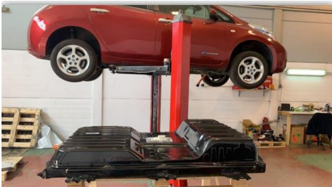
Εικόνα 6.1: Αφαίρεση του συσσωρευτή από το ηλεκτρικό όχημα Nissan Leaf. (Πηγή: EV battery rebuilds)
