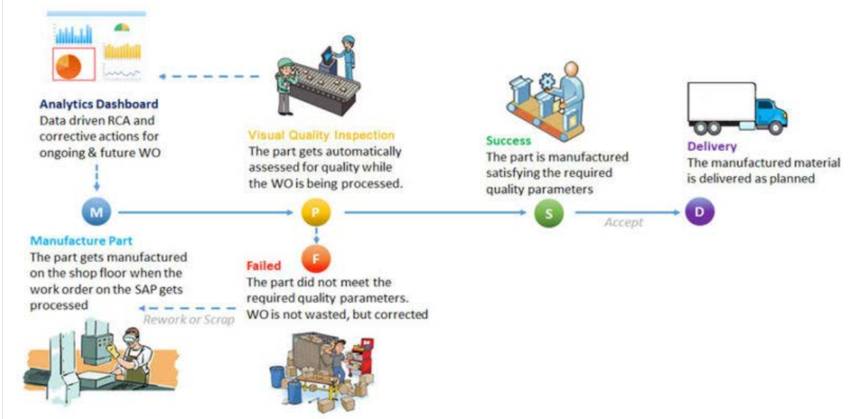
Εικόνα 3.3.12 – Διαδικασία Ελέγχου Ποιότητας με Χρήση Μηχανικής Μάθησης [212]
