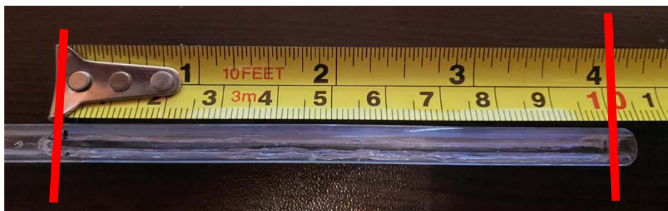
Εικόνα 64 Πλαστικός σωλήνας 10cm για την μέτρηση της ακρίβειας του rotary encoder
