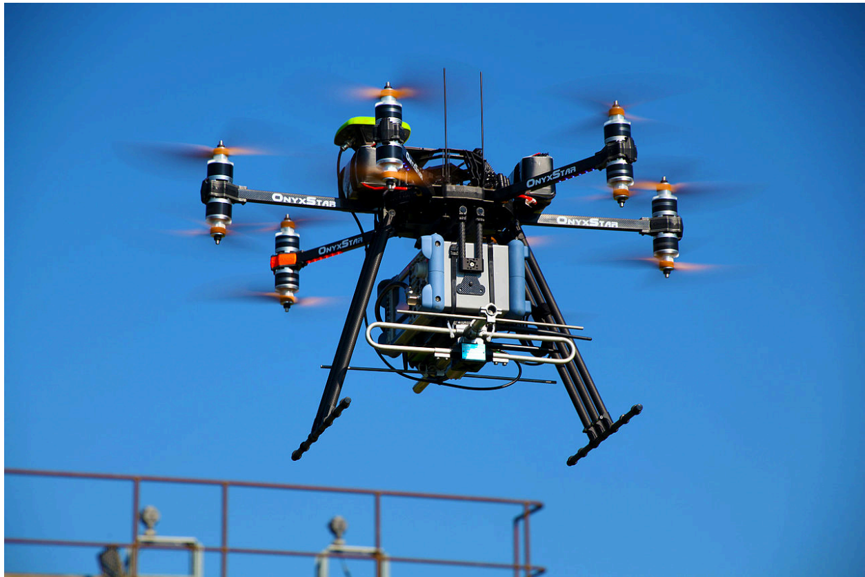
Εικόνα 3.7.5 OnyxStar HYDRA-12, εξακόπτερο με 2 ομοαξονικές έλικες σε κάθε κινητήρα [27]
