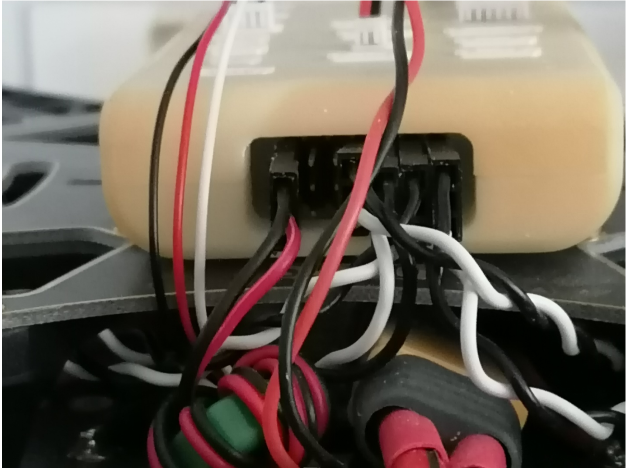
Εικόνα 7.5.2 Οι κινητήρες και το UBEC συνδεδεμένα στο servorail του FMUK66
