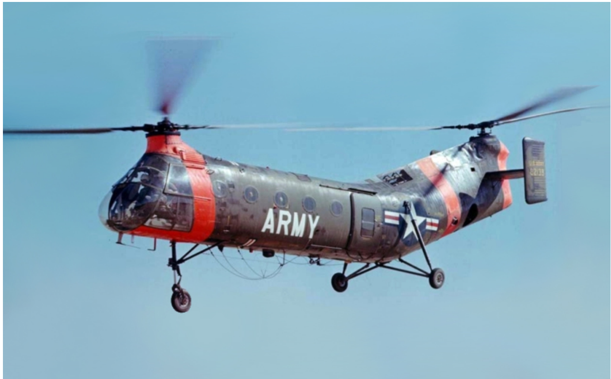
Εικόνα 3.7.2 Ελικόπτερο Piasecki H-21B με ρότορες σε διαφορετικούς άξονες [24]
