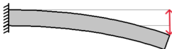
Εικόνα 8. Μέγιστο βέλος κάμψης σε πρόβολο.
