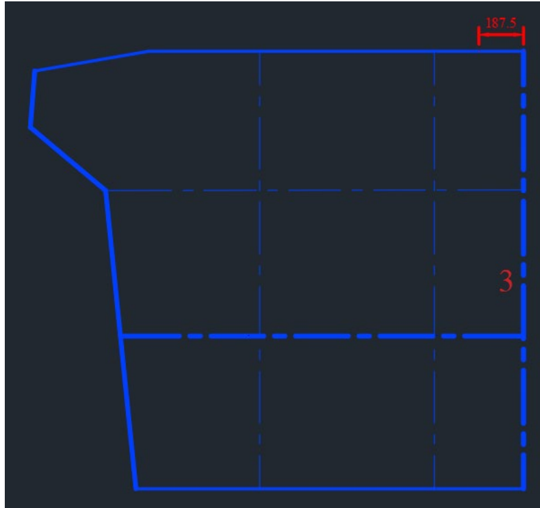
Εικόνα 30. Ημιπλάτος συνεργαζόμενου ελάσματος κύριου κατακόρυφου ενισχυτικού.
