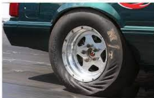
Εικόνα 14 Ελαστικότητα ελαστικού υπό φορτίο
