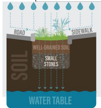
ΕΙΚΟΝΑ 9.21: Λύση όμβριων υδάτων στους πράσινους χώρους εμπνευσμένη από το παράδειγμα της Bryant Avenue
