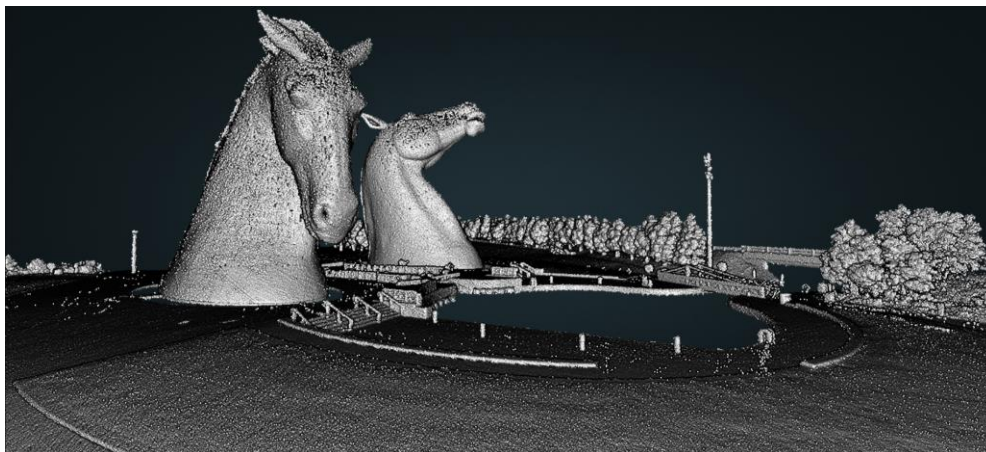
ΕΙΚΟΝΑ 8.10: Νέφος σημείων εξωτερικού χώρου ιστορικού μνημείου των αγαλμάτων "The Kelpies" στο Falkirk της Σκωτίας, διάρκεια σάρωσης 20'.
