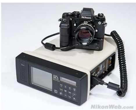
Φωτογραφία της Kodak DCS 100, μαζί με την «ψηφιακή μονάδα» της – από το site www.nikonweb.com
