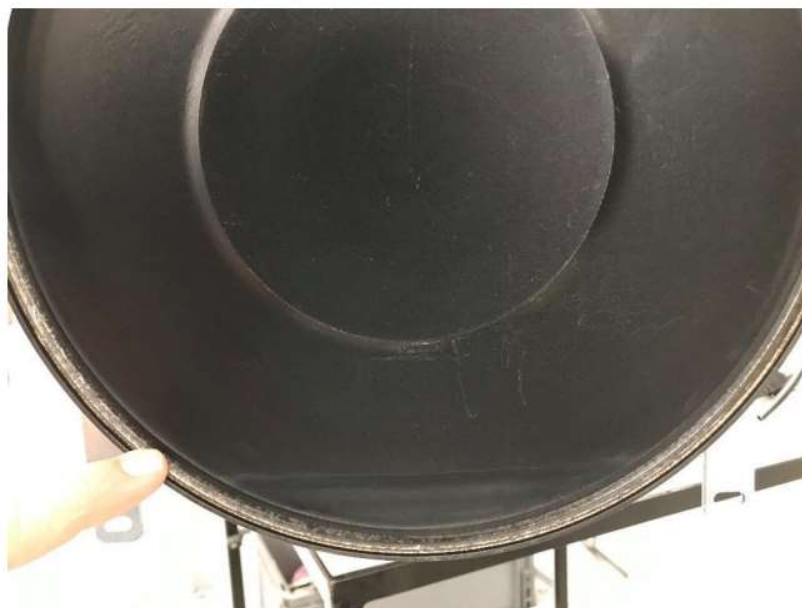
Εικόνα 5. Πόρτα κλιβάνου με βρωμιές που δημιουργούν συνήθως διαρροές.
