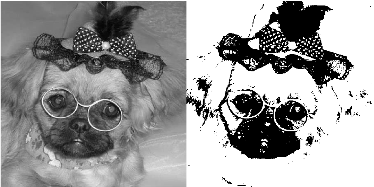
Εικόνα 12. Αριστερά απεικονίζεται μια εικόνα σε κλίμακα του γκρι, ενώ δεξιά απεικονίζεται η ίδια εικόνα που έχει περάσει από κατωφλιοποίηση με την μέθοδο Otsu.
