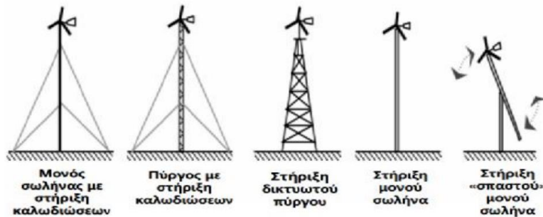
Εικόνα 6.15: Τρόποι στήριξης ανεμογεννήτριας μικρής ισχύος
