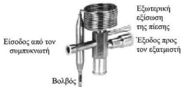
Εικόνα 1.11: Θερμοστατική βαλβίδα εκτόνωσης με εξωτερική εξίσωση πίεσης. [5]
