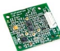
Σχήμα 5.4: Πλακέτα υποστήριξης ISB, Alphasense [193].
