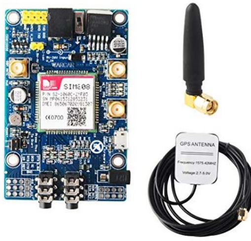
Σχήμα 5.13: SIM808 GPS/GPRS Module [199].
