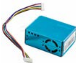
Σχήμα 5.9: Αισθητήρας μικροσωματιδίων (PMS5003) [195].
