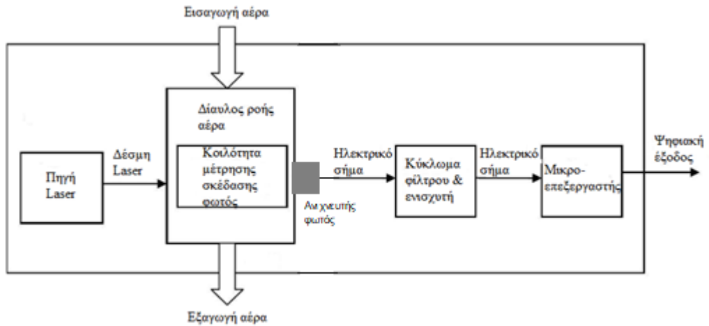
Σχήμα 4.2: Δομή οπτικού αισθητήρα μικροσωματιδίων, χαμηλού κόστους [190].
