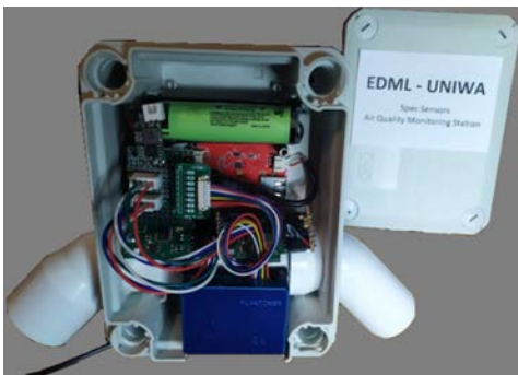
Σχήμα 7.1: Σταθμός παρακολούθησης ποιότητας αέρα με αισθητήρες αερίων ρύπων SpecSensor
