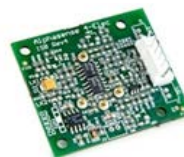
Σχήμα 5.7: Πλακέτα υποστήριξης ISB, Alphasense [193].
