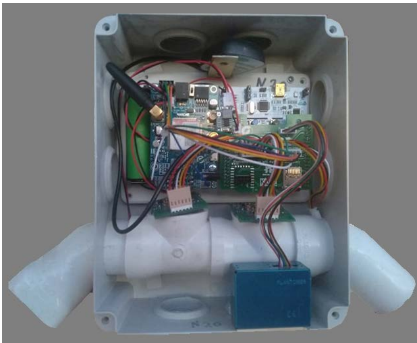
Σχήμα 5.24: Το εσωτερικό ενός συναρμολογημένου πλήρους σταθμού, μετά την τοποθέτηση όλων των εξαρτημάτων.
