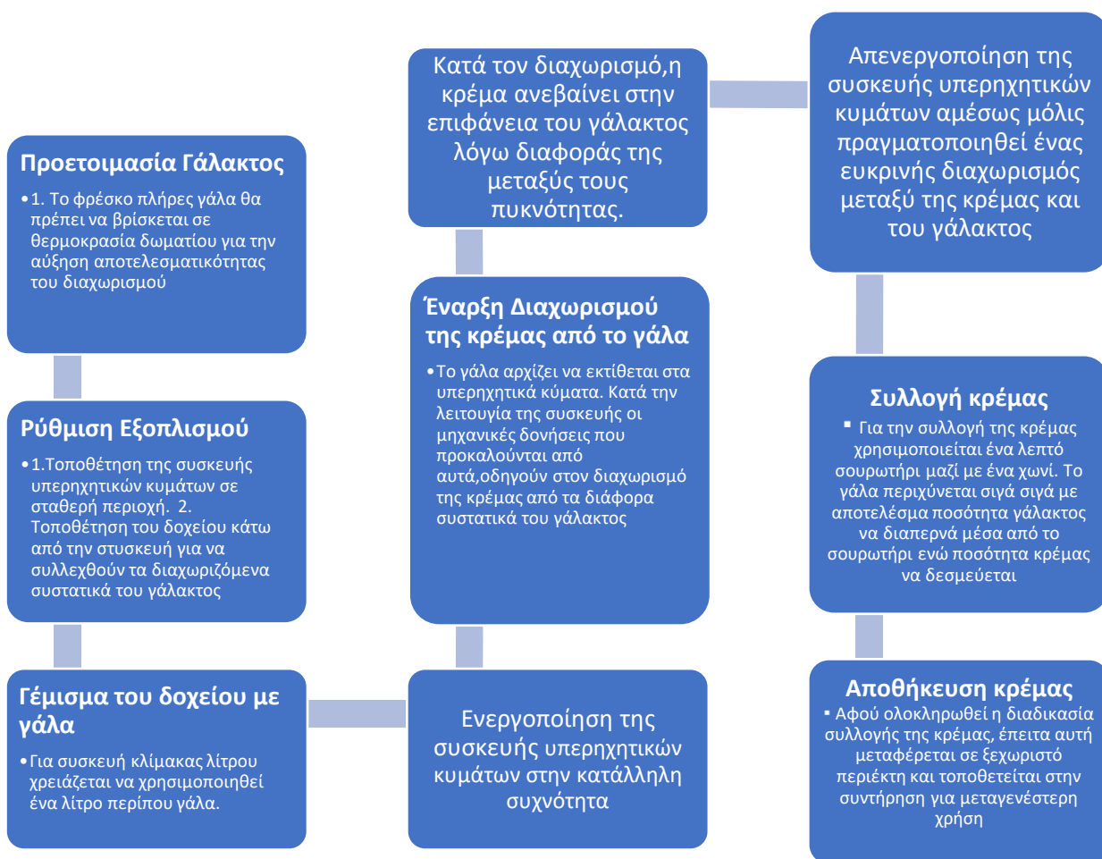
Σχήμα 3. Περιγραφή μεθόδου αποκορύφωσης του γάλακτος με συσκευή υπερηχητικών κυμάτων
