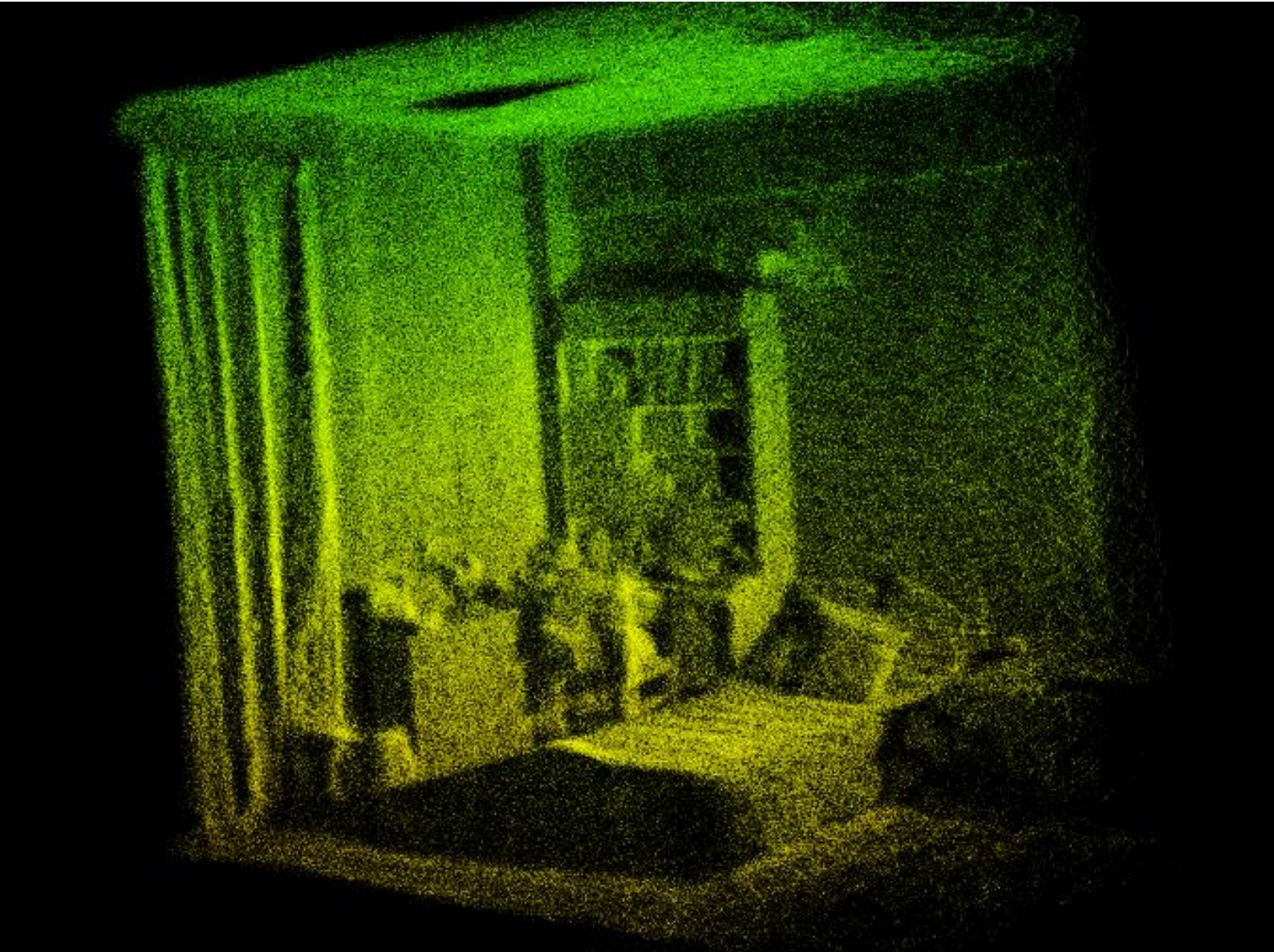
Εικόνα 57: Αποτέλεσμα Faster-LIO– καταγραφή εσωτερικού χώρου
