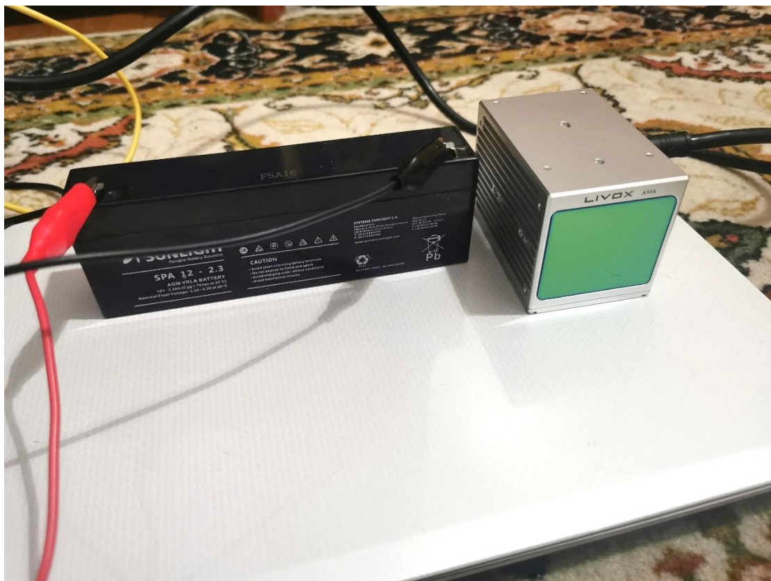
Εικόνα 27: Διάταξη εφαρμογής (Σαρωτής LIVOX AVIA με ενσωματωμένο IMU, μπαταριά, φορητός υπολογιστής)
