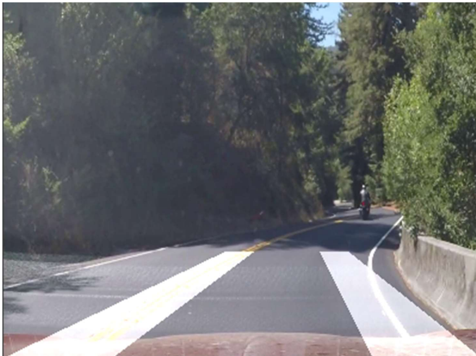
Εικόνα 5.2.2 Παράδειγμα περιοχής ενδιαφέροντος γραμμών λωρίδας
