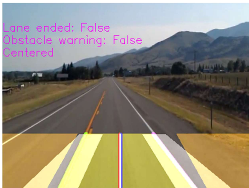
Εικόνα 5.2.10 Τελικό στιγμιότυπο του εντοπισμού λωρίδας
