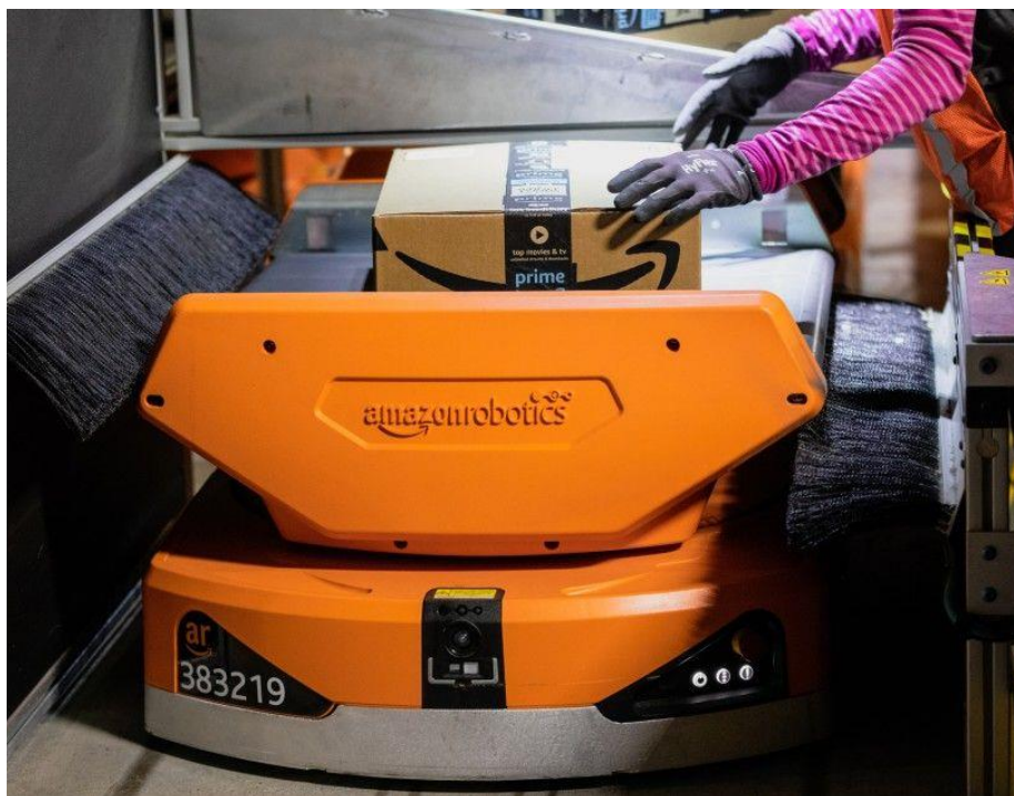
Εικόνα 9 Pegasus robot με την προσθήκη μεταφορικού ιμάντα Πηγή: https://www.allaboutlean.com/amazon-robotics-family/
