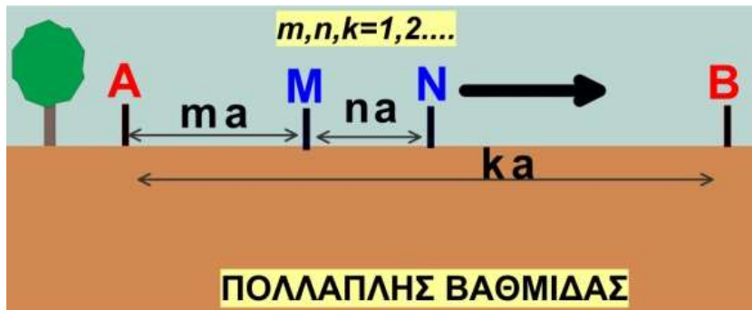
Εικόνα 16. Η διάταξη μέτρησης πολλαπλής βαθμίδας (multiple gradient).
