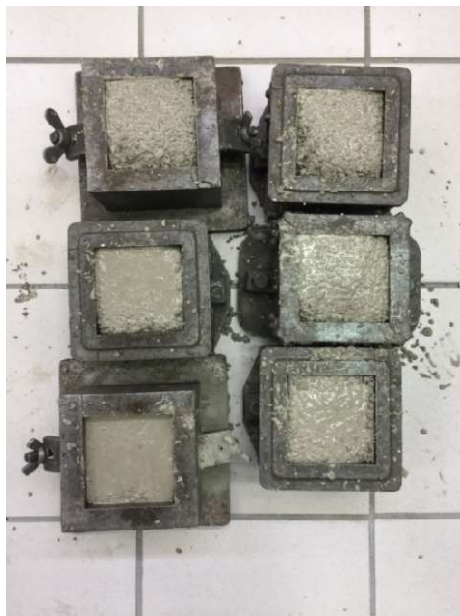
Εικόνα 14 - Τοποθέτηση μίγματος στις μήτρες προτυποποιημένης βιομηχανικής σύνθεσης με μικρή διαφοροποίηση ως προς το είδος άμμου που χρησιμοποιήθηκε.
