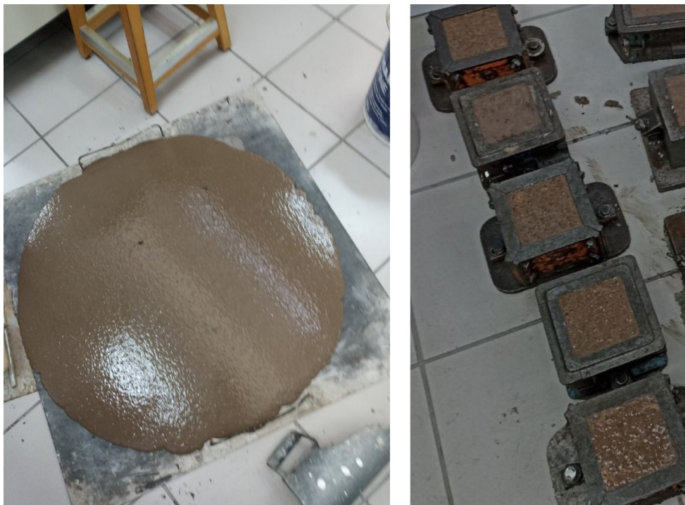
Εικόνα 16 - Εξάπλωση μίγματος και τοποθέτηση στις μήτρες για την 1 η σύνθεση.
