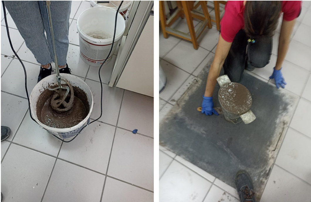
Εικόνα 15 - Ανάμιξη και δοκιμή εξάπλωσης για την 2 η σύνθεση.
