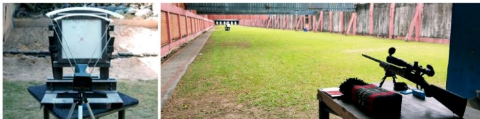
Εικόνα 4 - Διάταξη βολής στον στόχο με το ινοπλισμένο σκυρόδεμα. {Jamnana S. et al., 2020}
