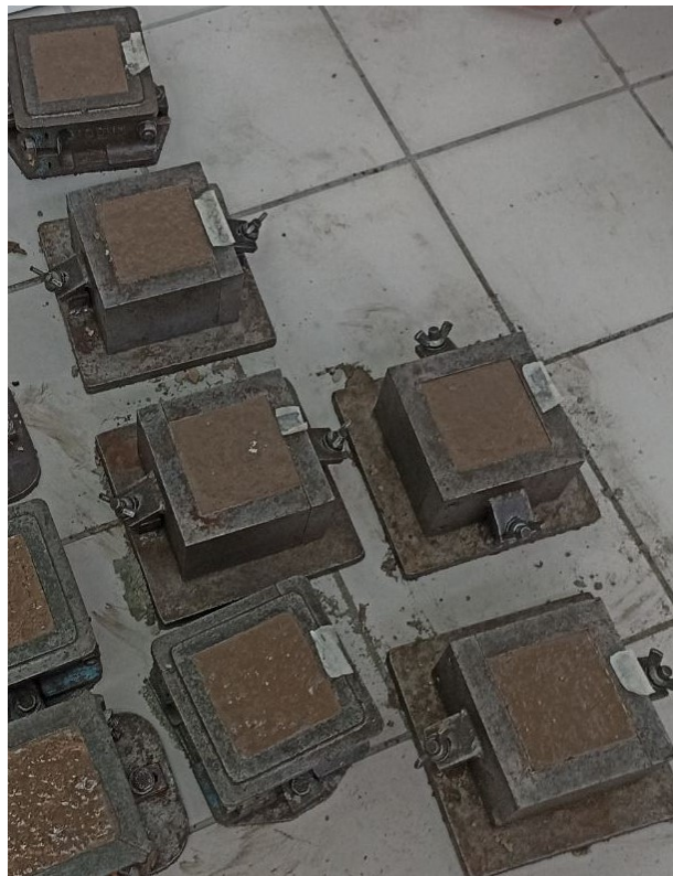
Εικόνα 17 - Τοποθέτηση μίγματος στις μήτρες για την 2 η σύνθεση.
