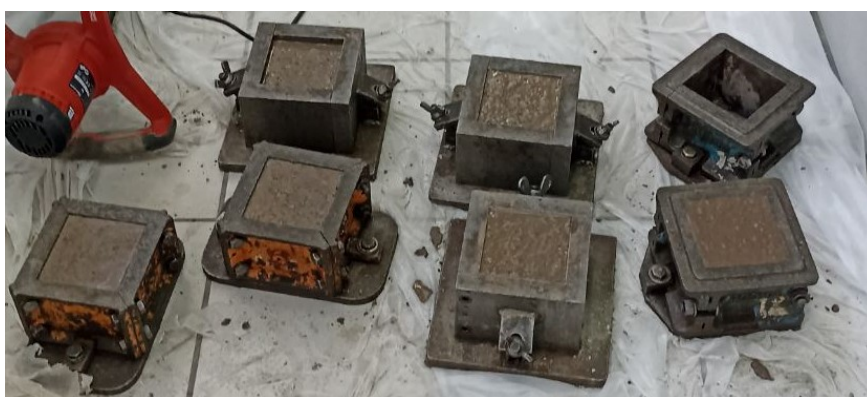
Εικόνα 18-Τοποθέτηση μίγματος στις μήτρες για την 3 η σύνθεση.
