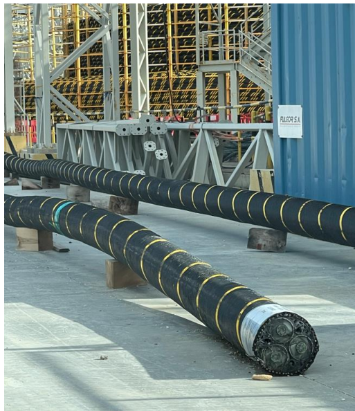
Εικόνα 10: Εσωτερική και εξωτερική απεικόνιση του καλωδίου το οποίο φορτώθηκε στο πλοίο «Αταλάντη».
