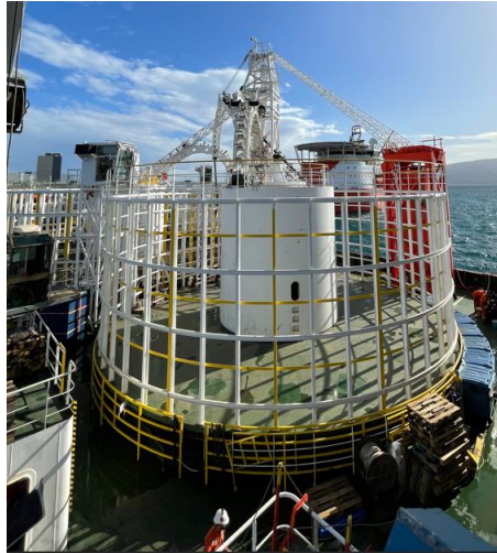
Εικόνα 9: Στο μπροστινό μέρος της εικόνας βρίσκεται η μικρή περιστρεφόμενη τράπεζα, ενώ αριστερά στο βάθος απεικονίζεται η μεγάλη περιστρεφόμενη τράπεζα.
