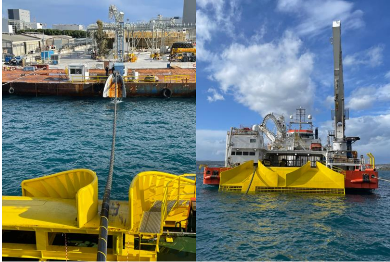
Εικόνα 4: Στην αριστερή πλευρά απεικονίζεται η μία γλίστρα και η μεταφορά του καλωδίου από το εργοστάσιο στο πλοίο, ενώ στη δεξιά εικόνα απεικονίζονται πανοραμικά και οι δύο γλίστρες που διαθέτει το πλοίο «Αταλάντη».
