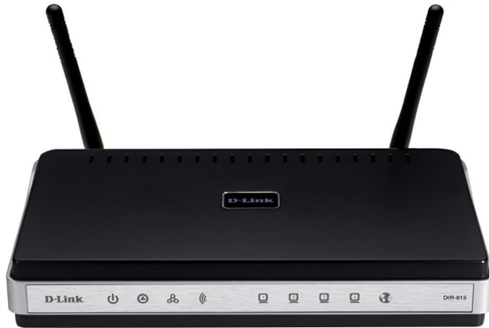
Σχήμα 3,1,5 – Router / Access Point
